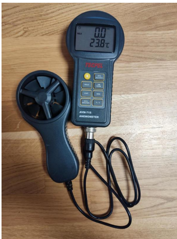
Slika 10. Mjerni instrument za mjerenje brzine zraka
