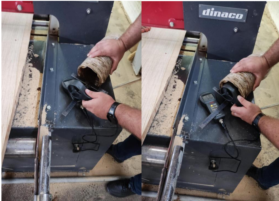
Slika 13. Prikaz mjerenja brzine strujanja zraka a) na udaljenosti 0,75*d i b) na udaljenosti 0*d
