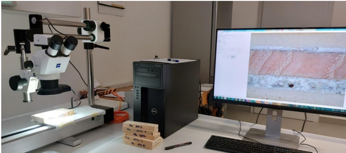
Slika 5. Skeniranje iobrađenih izvrtaka poljskog jasena
