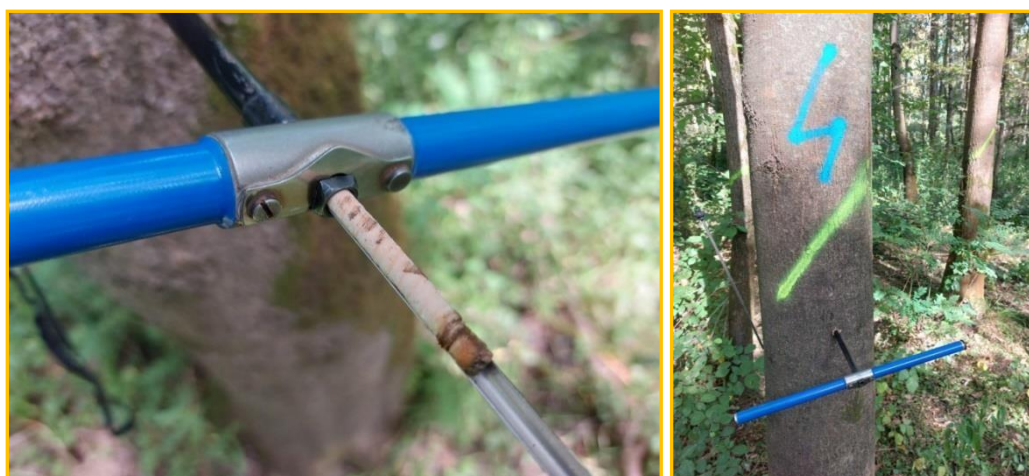
Slika 4. Označavanje stabala poljskog jasena i uzimanje drvnih izvrtaka
