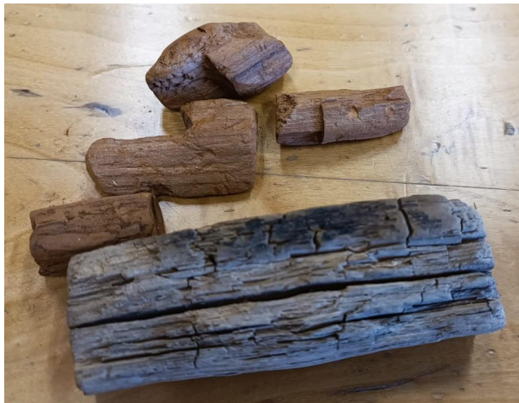
Slika 8. Uzorci drva napadnuti gljivama uzročnicama smeđe truleži (Izvor: Zbirka uzoraka Fakulteta šumarstva i drvne tehnologije )
