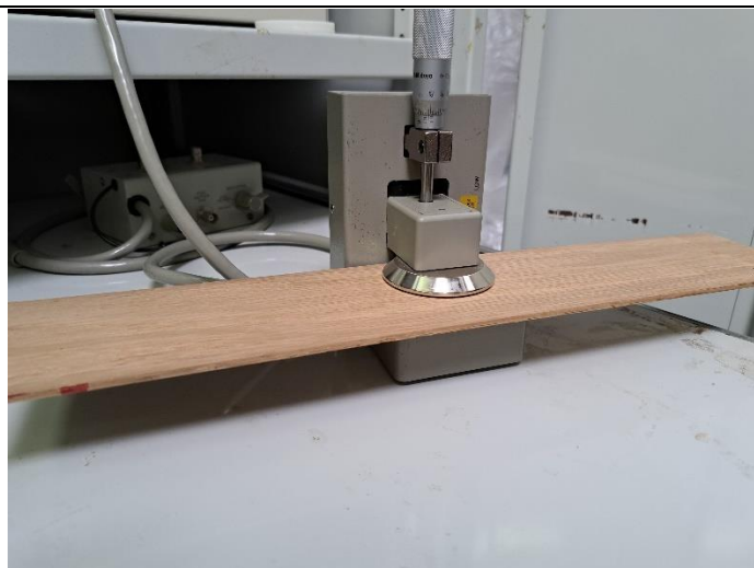
Slika 39. Hrastova lamela unutar ispitnog električnog polja
