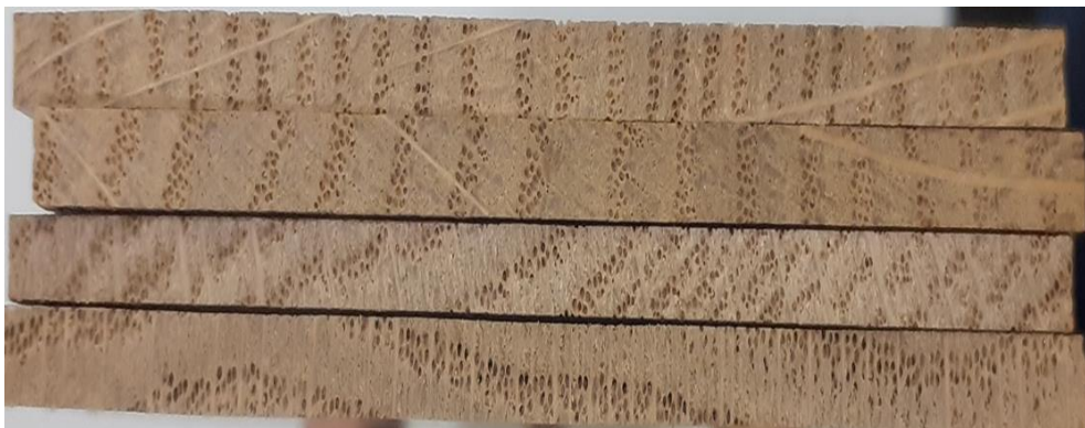
Slika 37. Primjer širina godova hrastovih lamela korištenih u eksperimentu ( prve dvije lamele su radijalnog presjeka, dok su druge dvije tangentnoga presjeka )
