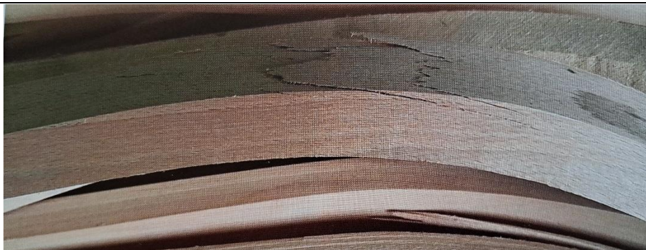
Slika 20. Tipična pukotina na bukovom elementu nastala pri savijanju (Milić, 2020)
