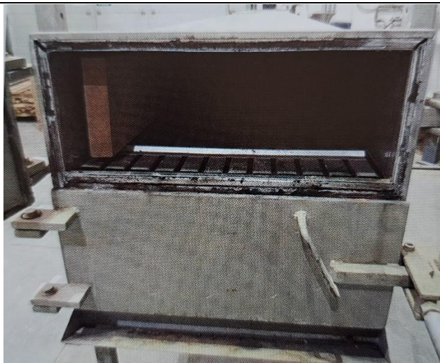
Slika 14. Prostor parionice u koji se postavljaju elementi za savijanje (Milić,2020)
