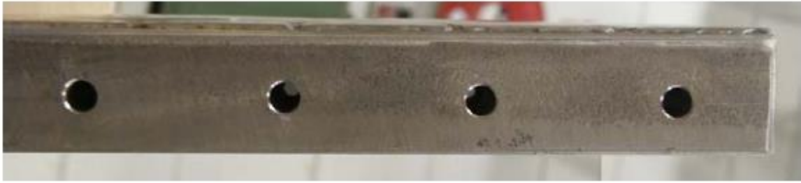
Slika 30. Rupe za izlaz vodene pare na metalnim ograničavajućim letvicama (Sandberg i Johansson,2005)
