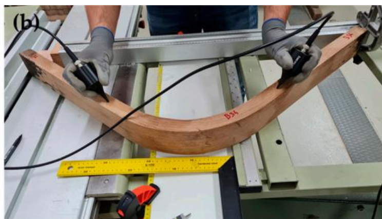
Slika 27. Određivanja prolaska brzine ultrazvuka kroz savijene uzorke (Straže i sur.,2023)
