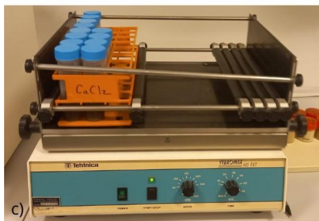
Slika 11 a,b) priprema uzoraka, c) mućkalica, d) mjerenje pH vrijednosti pH-metrom
