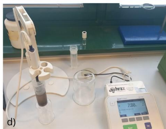
Slika 11 a,b) priprema uzoraka, c) mućkalica, d) mjerenje pH vrijednosti pH-metrom
