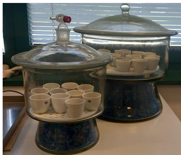
Slika 13 Uzorci tla u eksikatoru nakon sušenja na 105 °C
