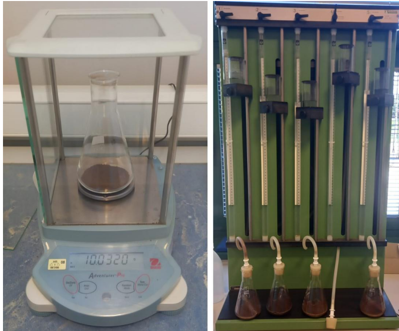
Slika 1 Lijevo: analitička vaga, desno: kalcimetar
