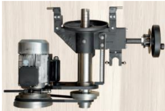
Slika 20. Remenski prijenos gibanja glavnog motora
