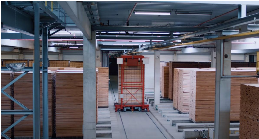
Slika 8. Automatsko vođeno vozila za punjenje sušionice (Izvor: https://www.youtube.com/watch?v=qlcqRVI7N5c&ab_channel=PollmeierMassivholz )
