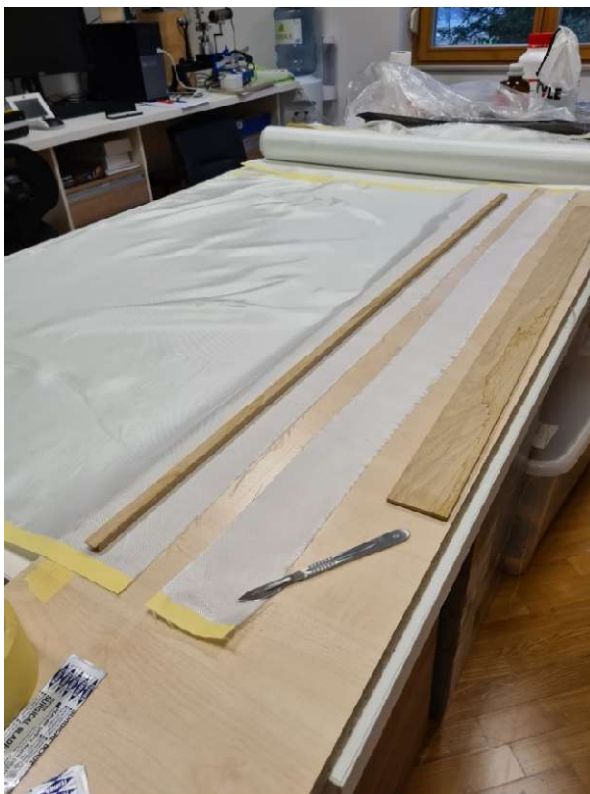
Slika 9a. Priprema staklenih vlakana
