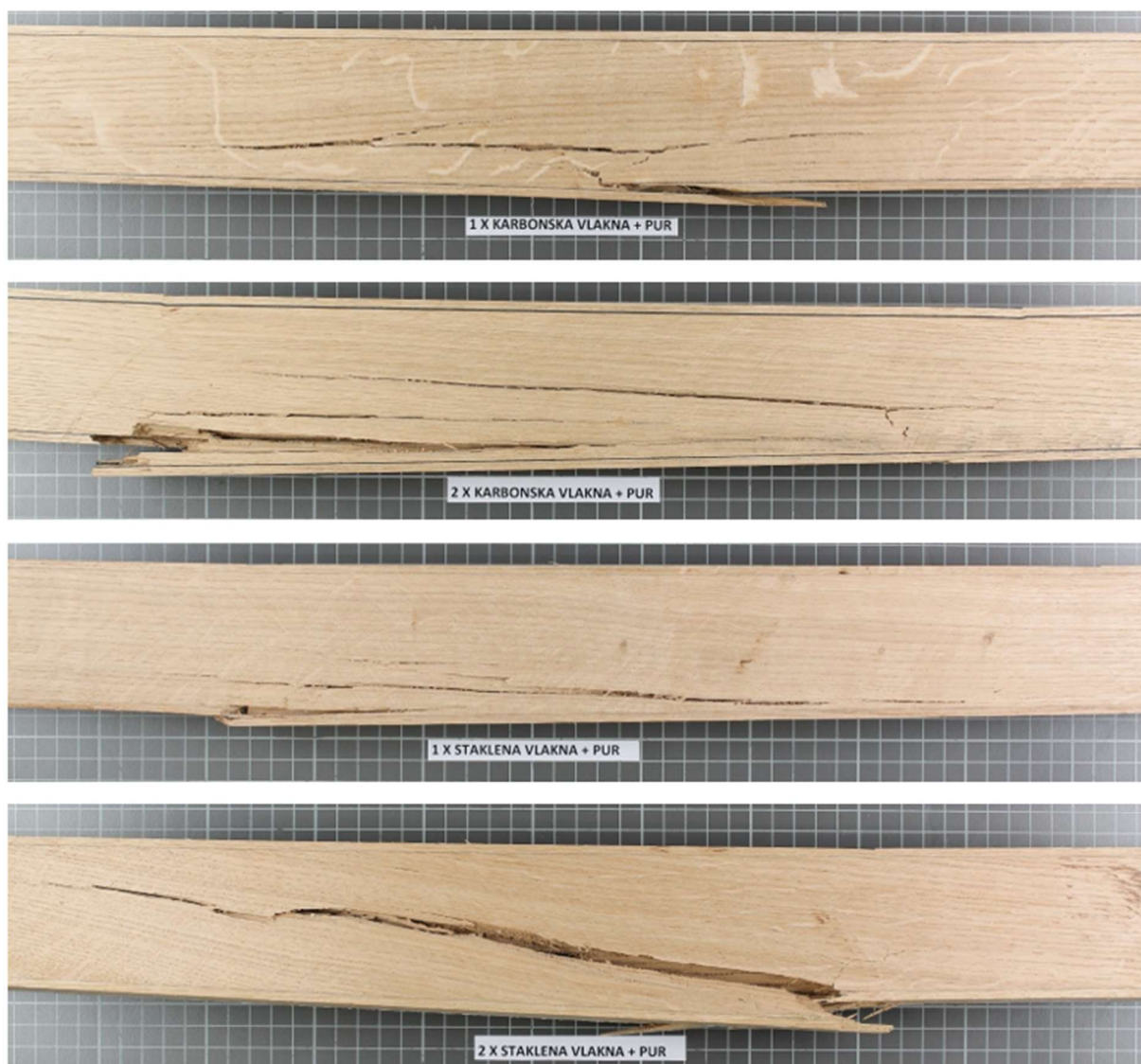
Slika 19. Referentni uzorak svake od grupa ispitanih uzoraka nakon loma
