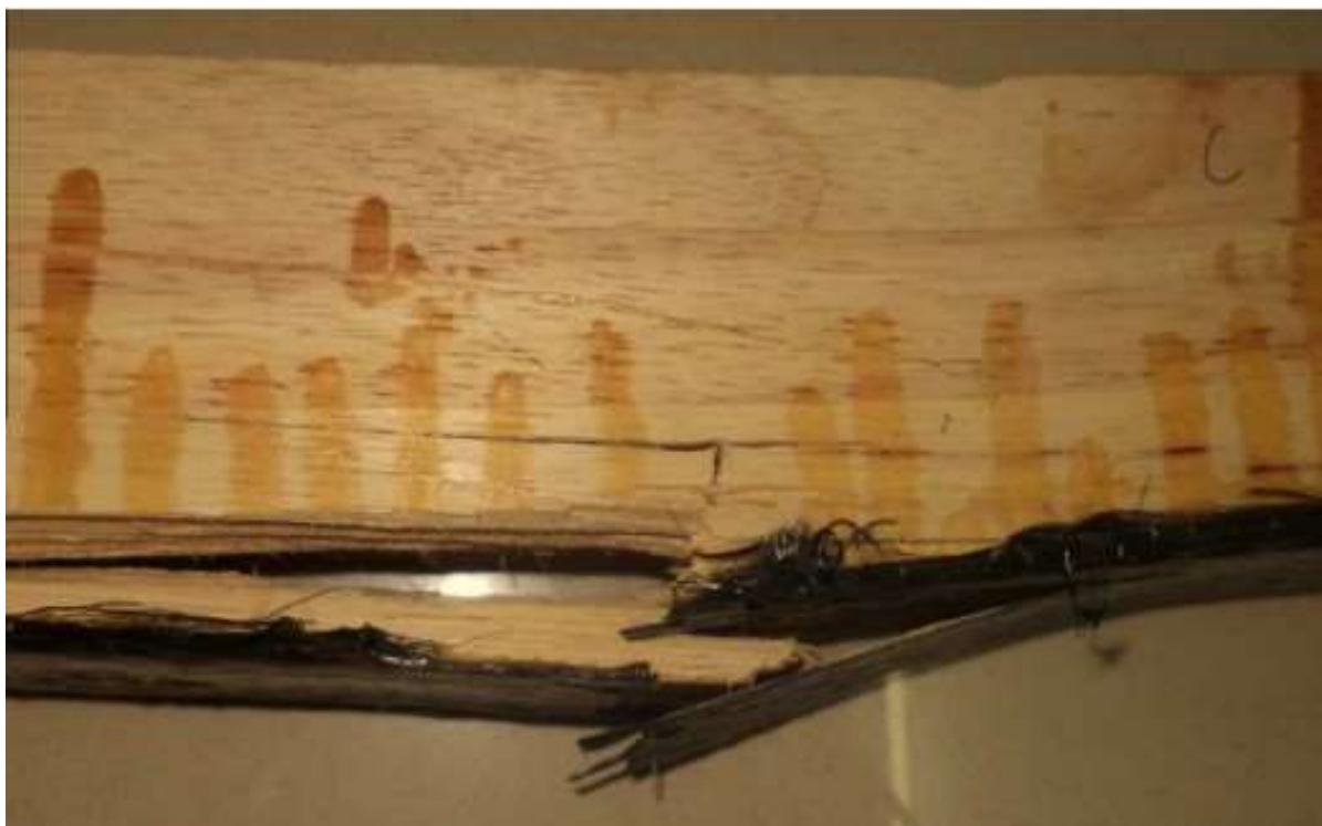
Slika 7. Tipičan lom uslijed savijanja lamelirane gredice ojačane jednim slojem CFRP trake (Nadir i ostali, 2016.)
