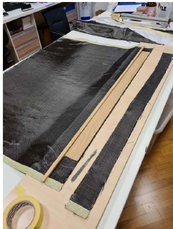
Slika 9b. Priprema ugljičnih vlakana
