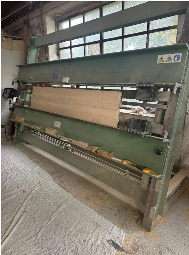
Slika 5: Lamelirani elementi u preši
