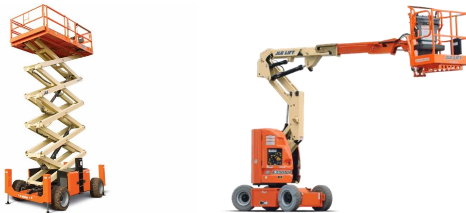
Slika 15. Podizna zglobna platforma (lijevo) i škarasta podizna platforma (desno) Izvor: https://www.rival.com/hr/najam/platforma-za-rad-na-visini/ (Pristupljeno 19.9.2024.)
