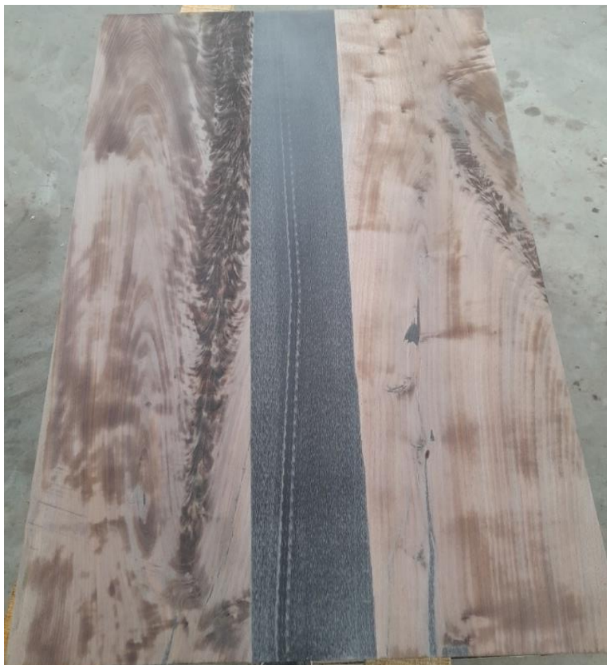
Slika 14. Brušenje stola s epoksidnom smolom
