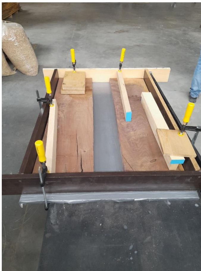
Slika 11. Stezanje piljenica u pod kalupa
