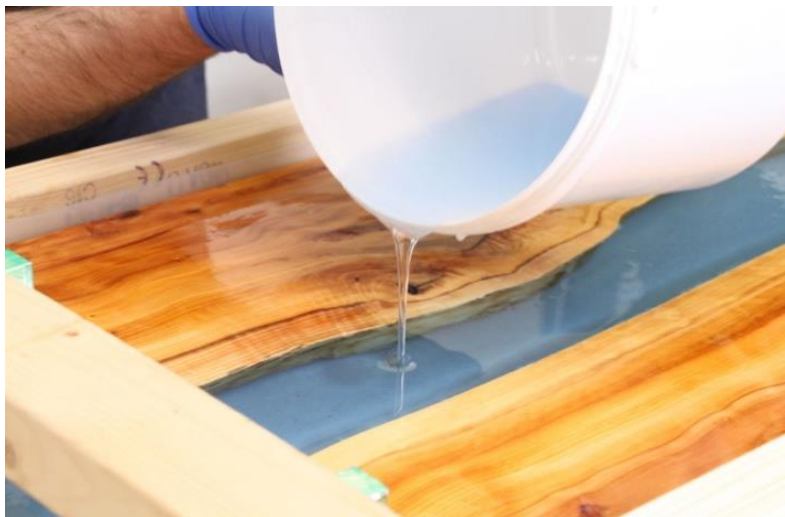
Slika 4. Izlijevanje epoksidne smole
