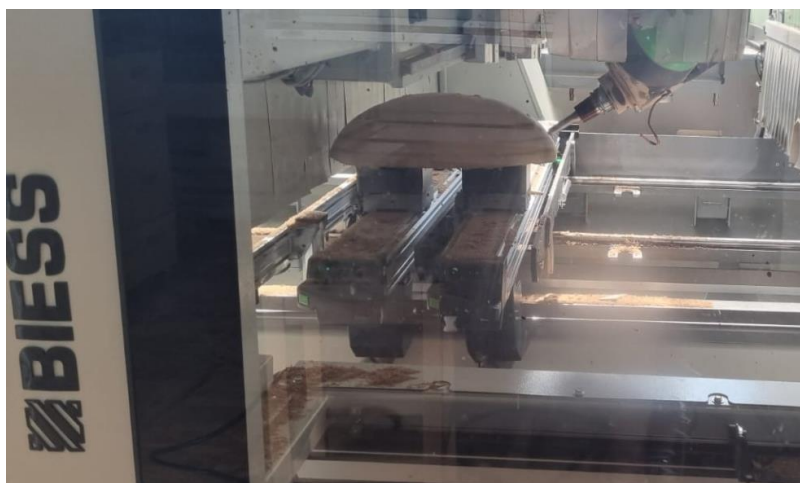
Slika 33. 5-osna izrada šablone
