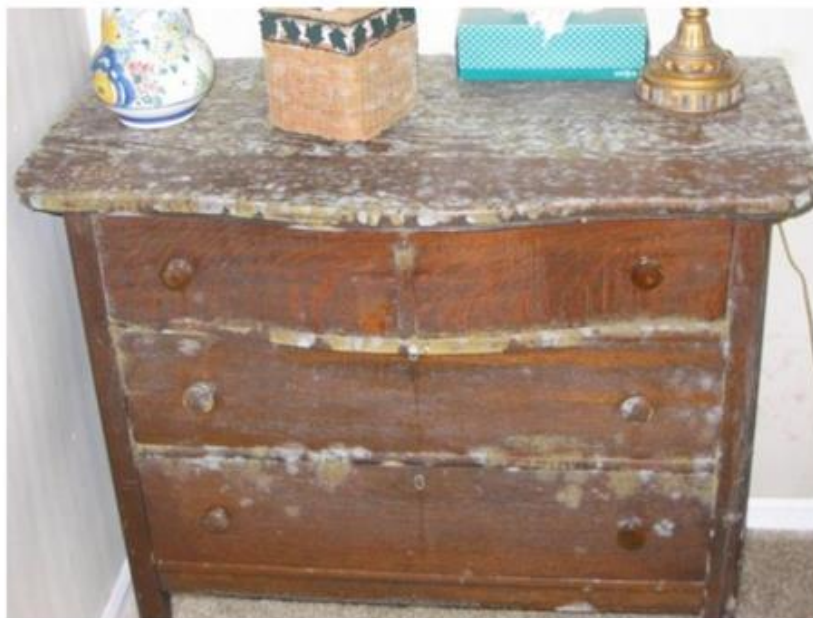
Slika 6. Ormarić oštećen utjecajem gljivica uslijed prevelike vlage.
