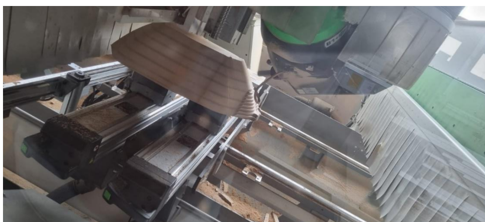
Slika 34. 5-osna obrada prototipa
