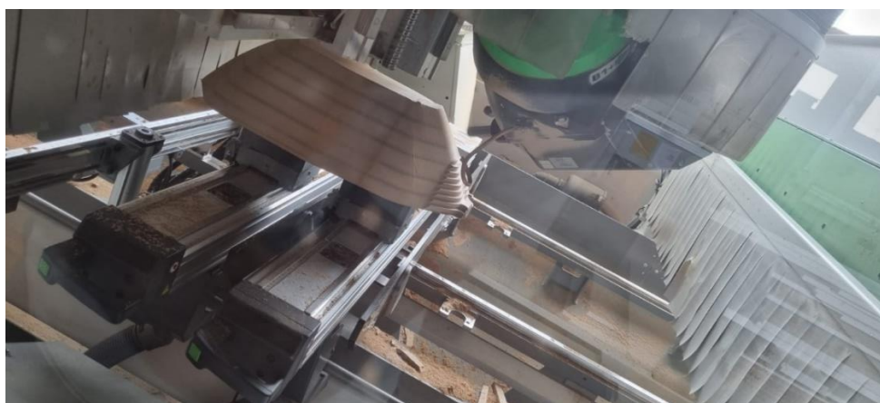
Slika 34. 5-osna obrada prototipa
