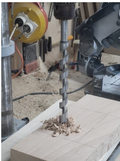
Slika 16. Uzorkovanje strugotine spiralnim svrdlom promjera \phi 16 mm (foto: Ivanda A., 2024.)
