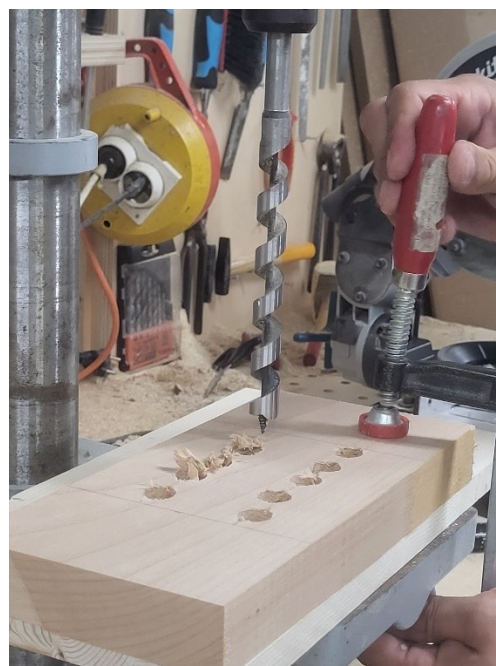
Slika 17. Rupe za uzorkovanje strugotine (foto: Ivanda A., 2024.)
