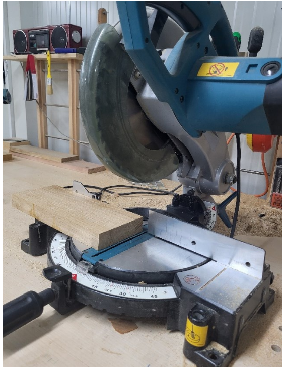
Slika 9. Stolna preklopna nagibna pila marke Makita (foto:Ivanda A., 2024.)
