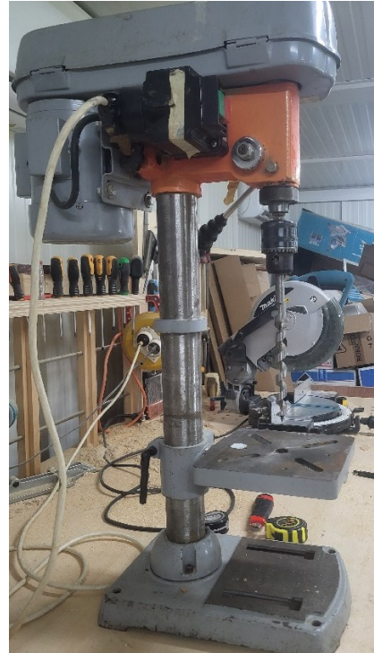
Slika 10. Stupna bušilica marke Einhell SB (foto:Ivanda A., 2024.)
