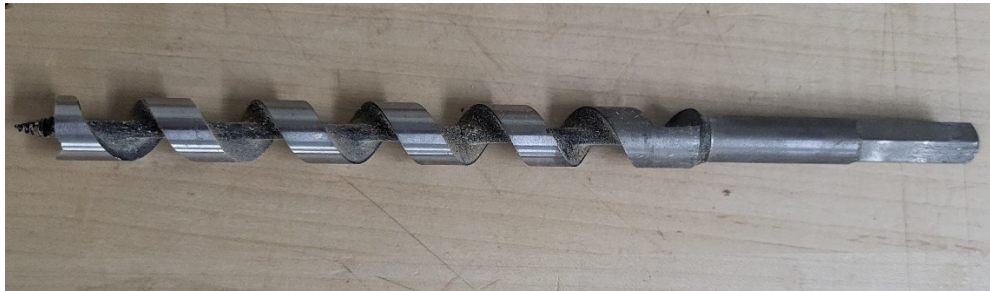
Slika 11. Spiralno svrdlo promjera \phi 16 mm (foto:Ivanda A., 2024.)
