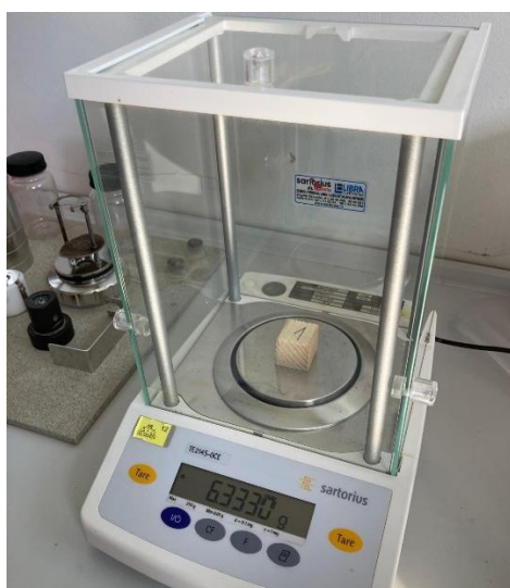
Slika 7. Mjerenje mase uzorka tehničkom vagom
