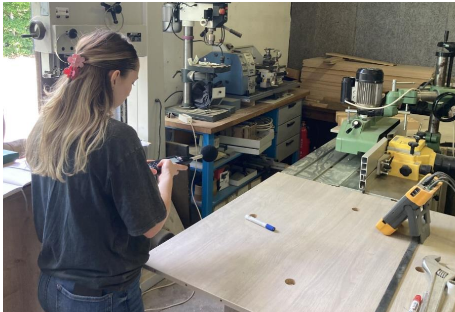
Slika 13. Mjerenje razine buke u praznom hoda stolne glodalice
