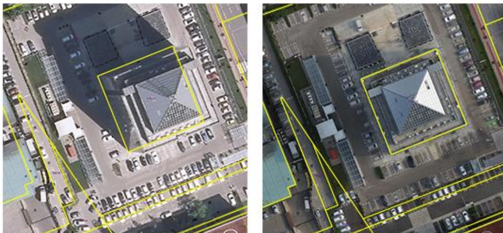
Slika 5. Razlika između ortofota i pravog ortofota
