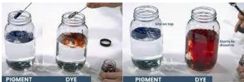
Slika 3. Priprema vodenog močila s pigmentima i bojilima
