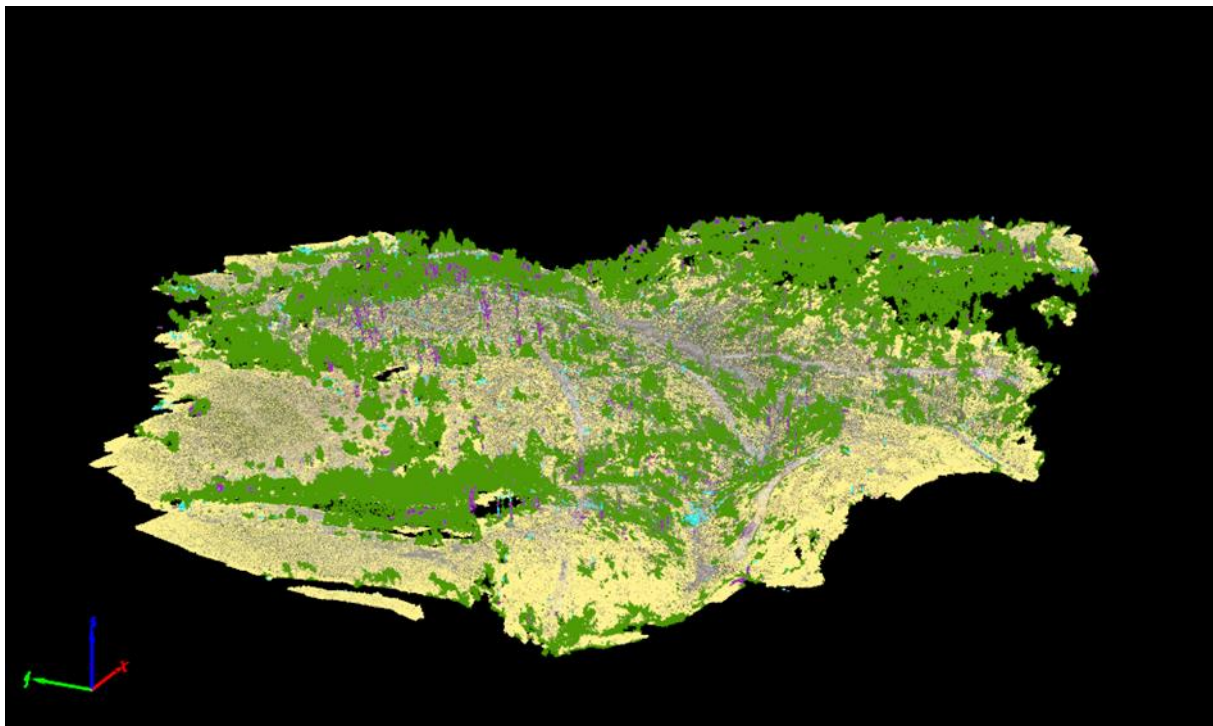
Slika 9. Klasificirani oblak točaka s prikazom boja kategorija istraživanog područja
