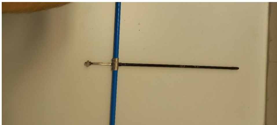
Slika 17. Svrdlo Haglöf 5,15mm sklopljeno za ubušivanje u stablo
