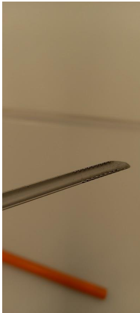
Slika 12. Zupci na vrhu izvlačača svrdla Djos 5,15mm
