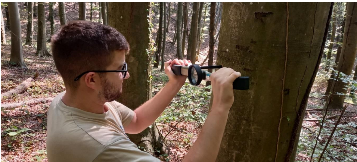
Slika 27. Očitavanje momenta sile svrdla Haglöf 10mm u bukovom stablu opetovanim naprezanjem ručke moment ključa
