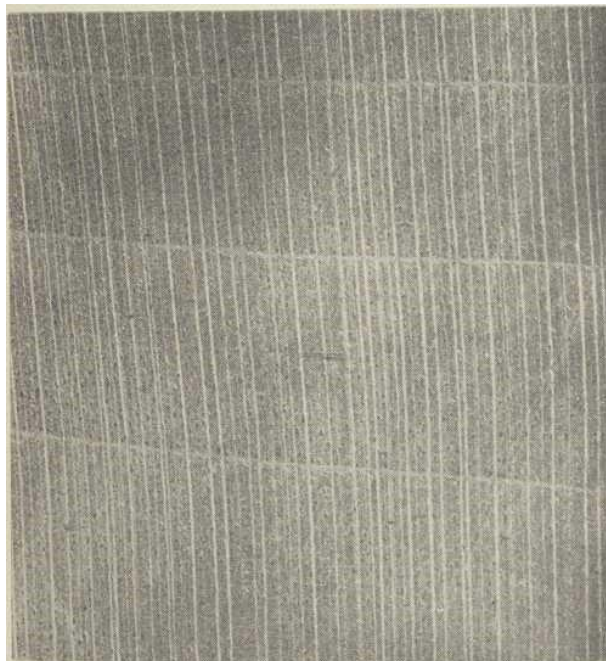
Slika 2. Poprečni presjek javorovog difuzno poroznog drva (Izvor: Hrvatska enciklopedija, svezak 5, str. 289-321, 1941.-1945. https://hemu.lzmk.hr/natuknica.aspx?ID=12948#ViewerPDF (pristupljeno 4.9.2024.))
