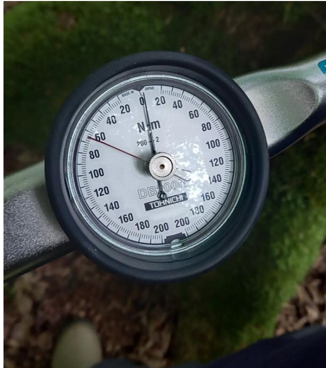
Slika 28. Sat moment ključa koji tijekom očitavanja pokazuje najveći očitani moment sile od 65Nm
