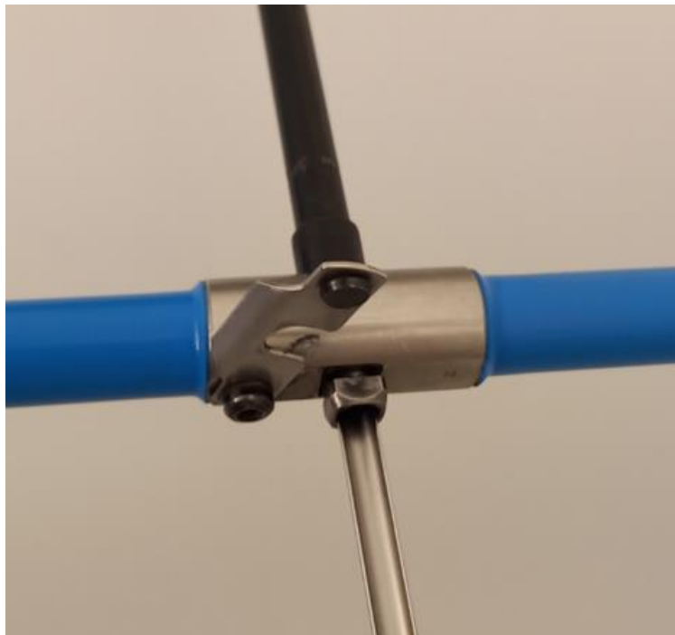
Slika 11. Ručka svrdla Haglöf 5,15mm s otkvačenim osiguračem i umetnutim izvlakačem
