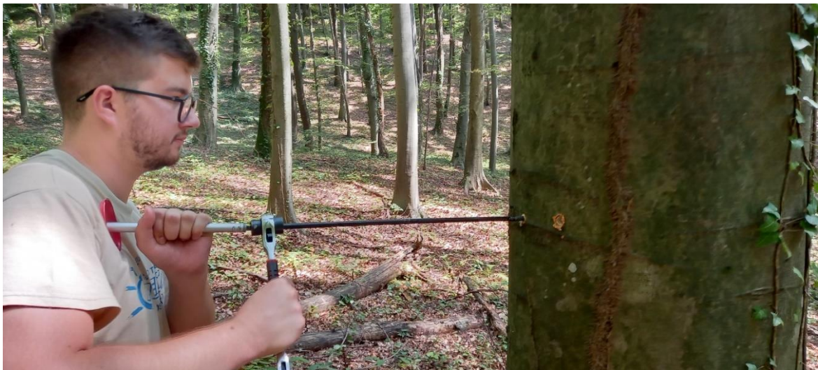
Slika 22. Primjena pushera i pomoćne rče pri početnom ubušivanju svrdla u stablo
