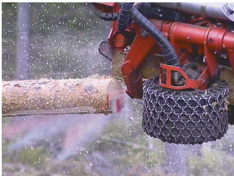
Slika 18. Prikaza obilježavanja trupaca bojom prilikom prerezivanja stabla pomoću harvestera (Izvor: Uusitalo 2010)
