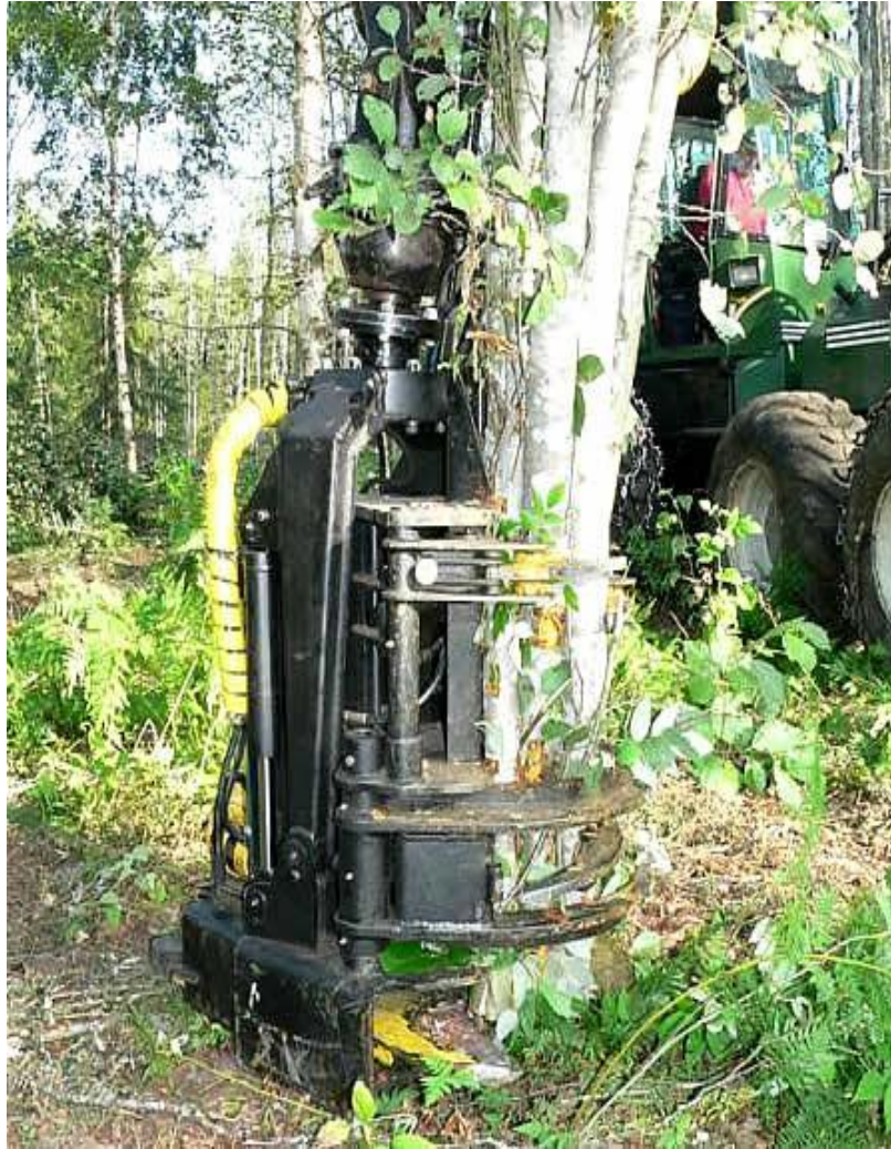
Slika 15. Harvesterska glava za pridobivanje energijskog drva
