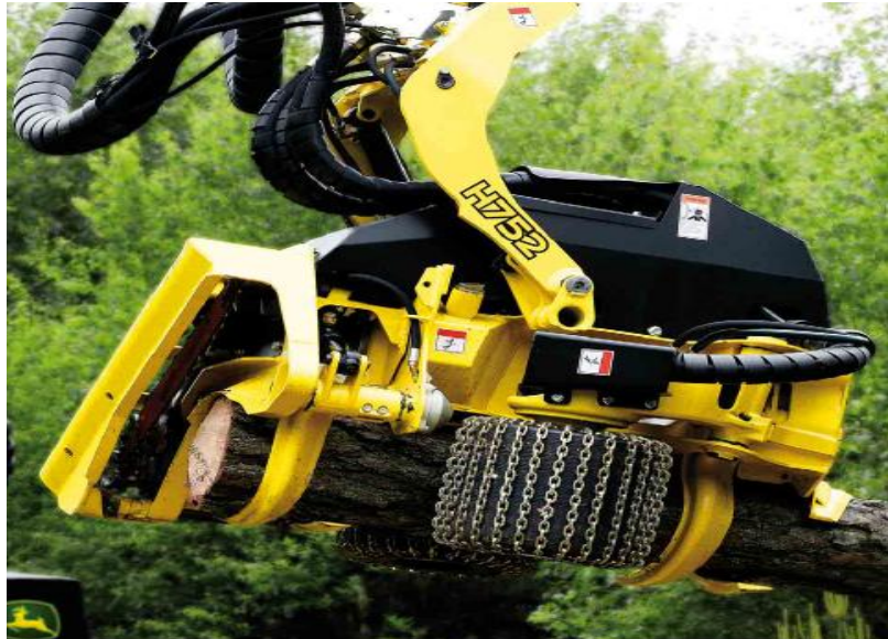
Slika 9. Harvesterska glava sa lančanom pilom
