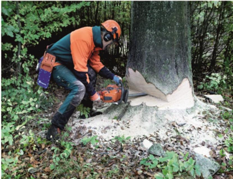
Slika 2. Ručno-strojna sječa i izradba drva
