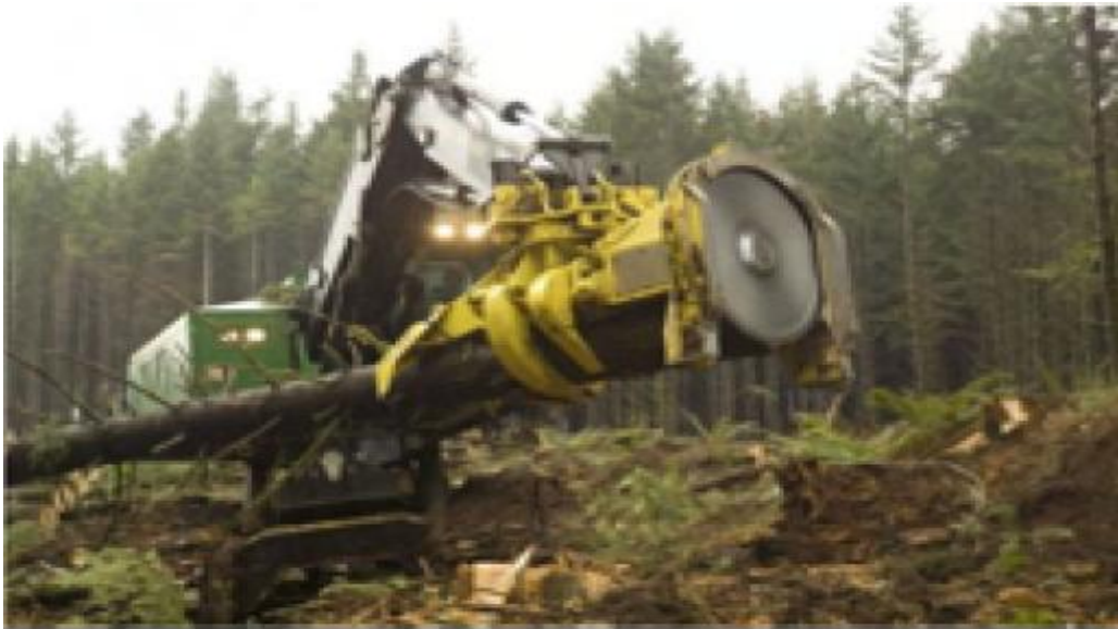
Slika 11. Sječna glava sa cirkularnom pilom
