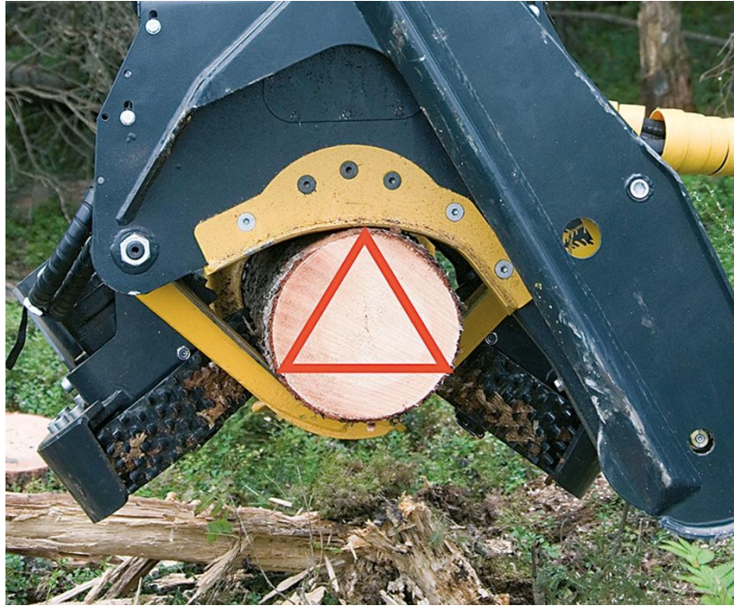
Slika 13. Princip mjerenja promjera (Izvor: Uusitalo 2010)
