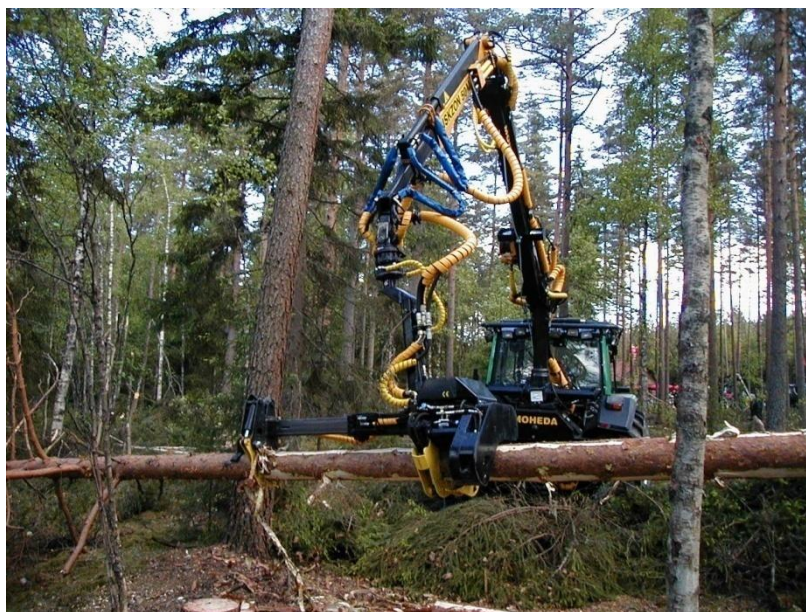
Slika 16. Harvesterska glava s taktnom tehnologijom (Izvor: Uusitalo 2010)
