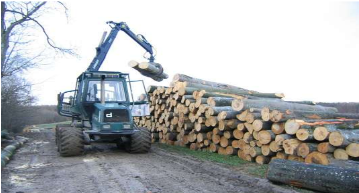
Slika 5. Forwader DASSER trs 10.08 prilikom istovara na pomoćnom stovarištu
