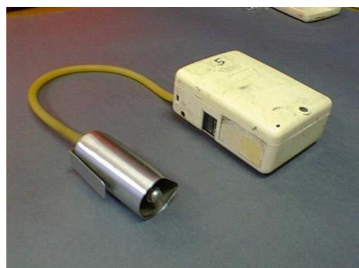
Slika 3.3 Mjerni uređaj A za sakupljanje respirabilnih čestica
