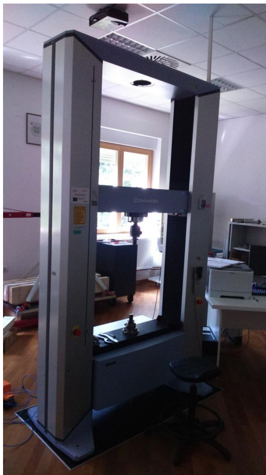
Slika 14. Univerzalni uređaj za ispitivanje mehaničkih svojstava
