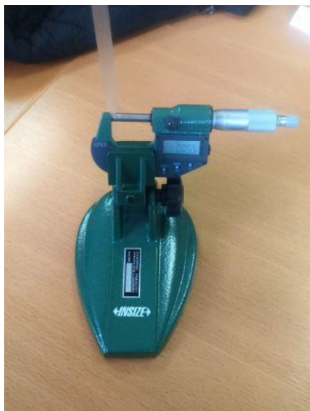
Slika 11. Mjerenje debljine suhog filma pomoću mikrometra
