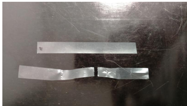
Slika 16. Izgled uzorka prije i poslije ispitivanja
