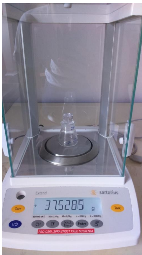
Slika 7. Mjerenje mase praznog piknometra
