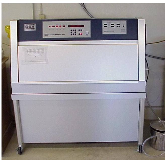
Slika 4. QUV uređaj za ubrzano izlaganje
