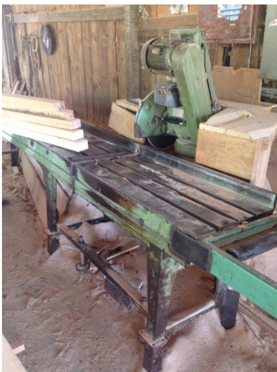
Slika 11. Kružna pila za poprečno raspiljivanje
