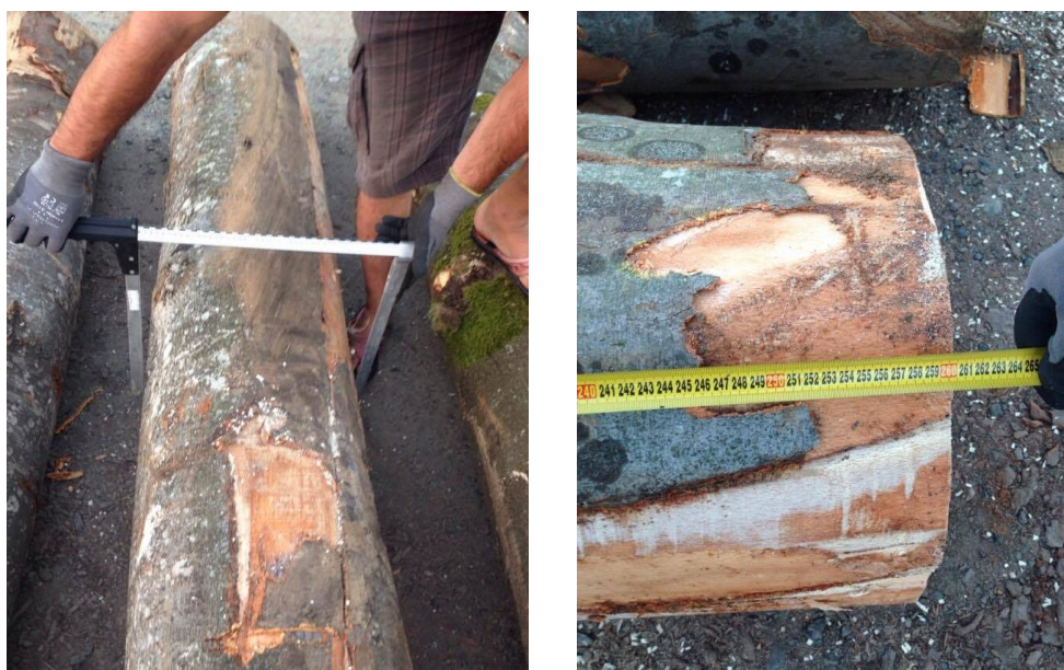
Slika 6. Mjerenje promjera i duljine trupaca
