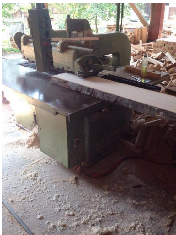
Slika 12. Kružna pila za uzdužno raspiljivanje
