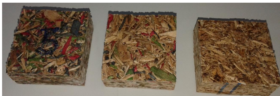
Slika 24: Uzorci ploča nakon izlaganja djelovanju vode kroz 24 sata - postojanost boje (Foto: Španić, 2016.)
