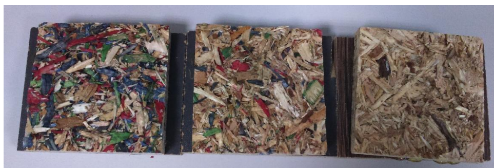
Slika 28: Presjek uzorka nakon ispitivanja čvrstoće raslojavanja (Foto: Brglez, 2016.)
