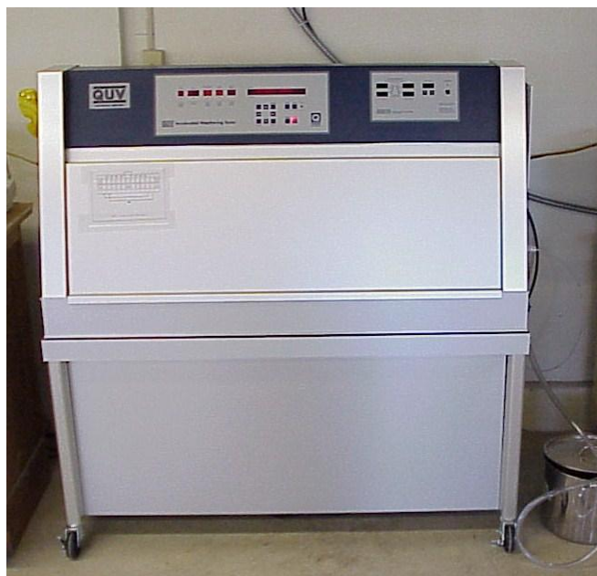
Slika 8. QUV uređaj za ubrzano izlaganje
