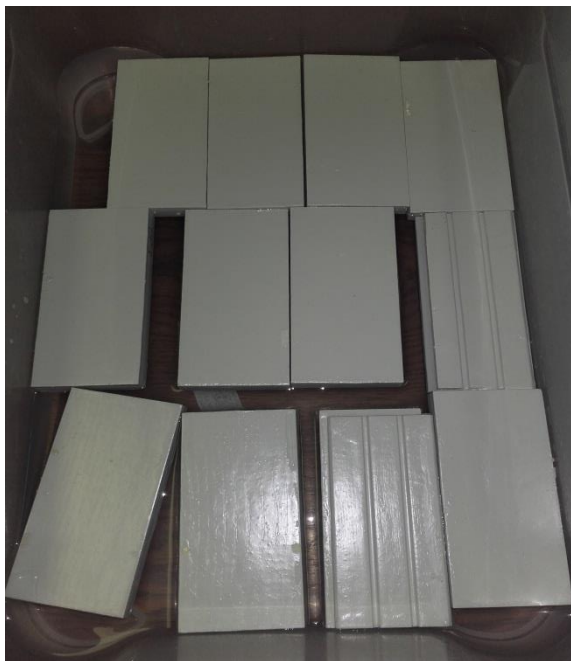
Slika 14. Uzorci postavljeni u vodu licem prema dolje
