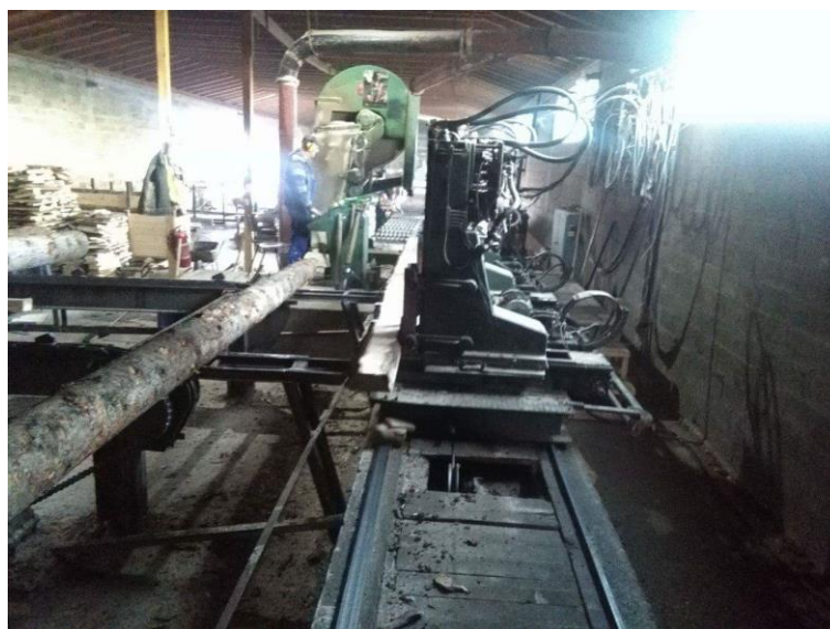
Slika 11. Prelaz trupaca preko lančanih transportera i tračna pila za raspaljivanje trupaca Unutrašnji transport može se odvijati kontinuirano i diskontinuirano.
