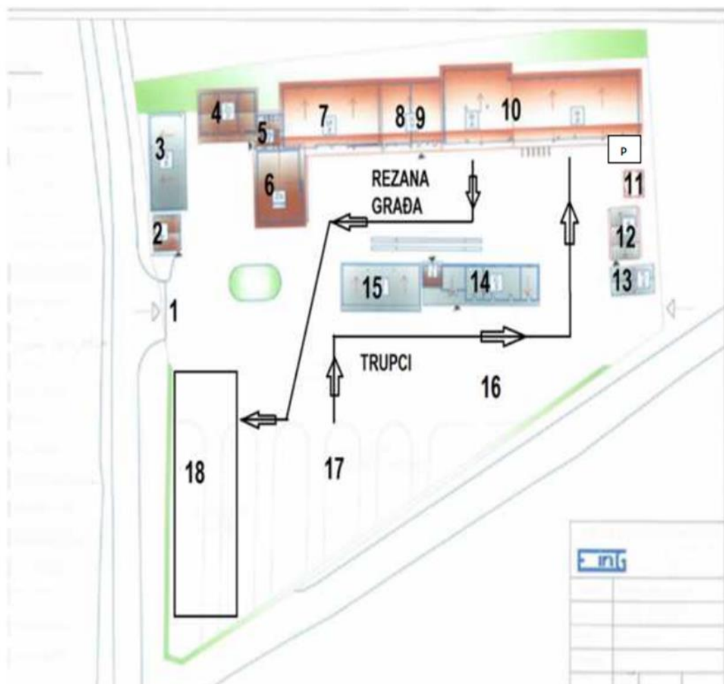
Slika 15. Prijedlog rasporeda proizvodnih jedinica u primarnoj proizvodnji-pilani (autorski rad)
