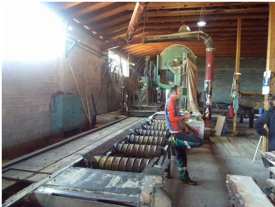
Slika 2. Prikaz tračne pile trupčare u promatranom poslovnom subjektu
