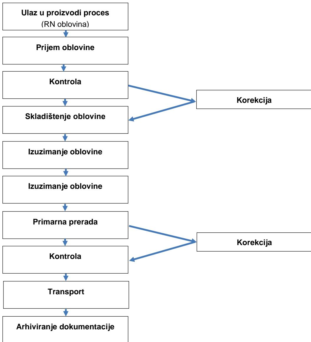
Slika 14. Prijedlog toka procesa proizvodnje rezane građe
