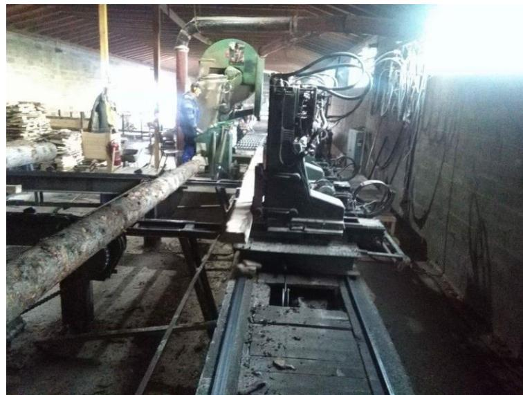
Slika 11. Prelaz trupaca preko lančanih transporterata i tračna pila za raspaljivanje trupaca
