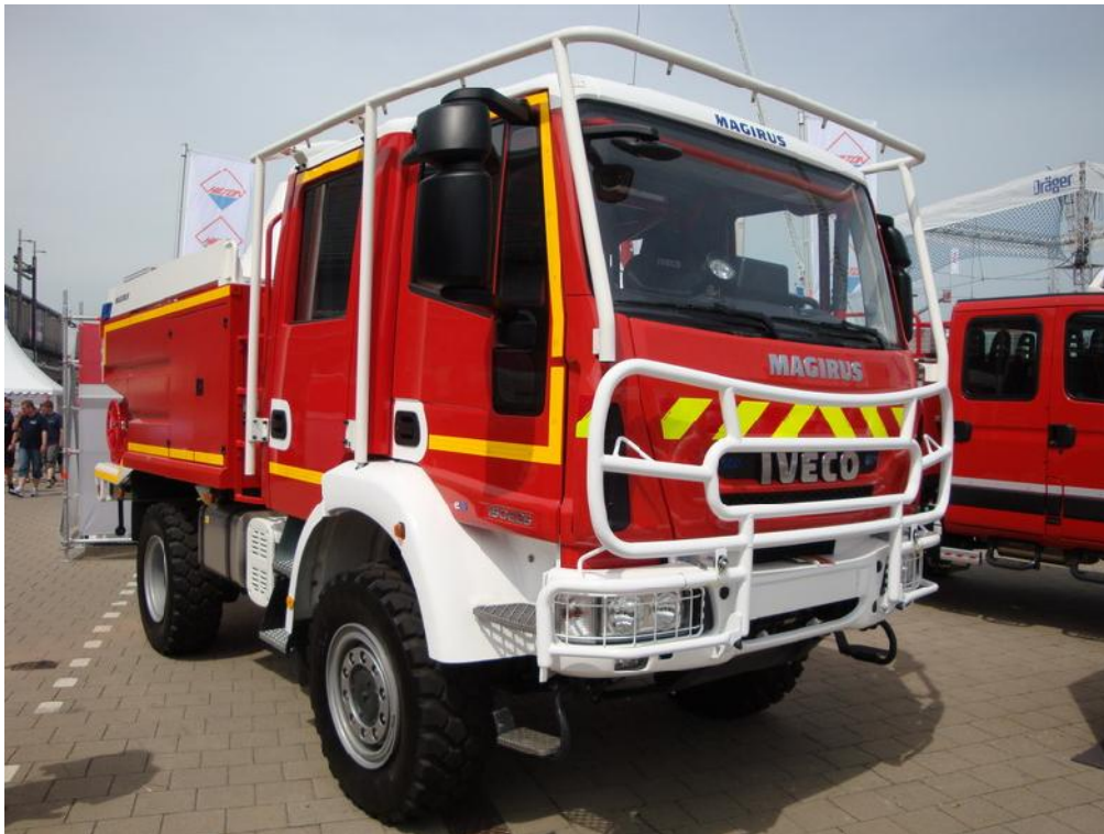
Slika 6. Zaštita kabine vatrogasnoga vozila
