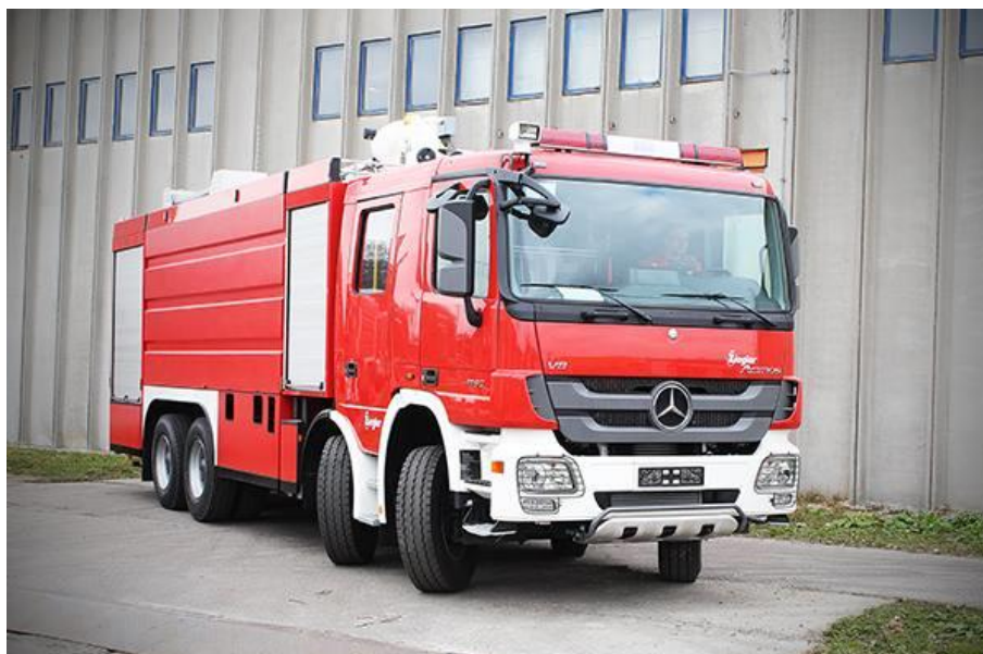
Slika 4. Vatrogasni kamion za gašenje šumskih požara s kabinom za četiri člana posade
