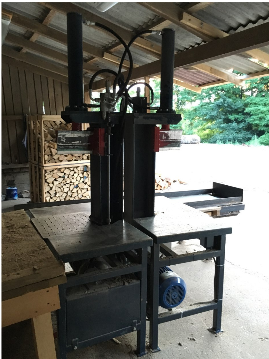
Slika 7. Cjepači kao sastavni dio specijaliziranog pogona za proizvodnju kratko rezanog i cijepanog ogrjevnoga drva
