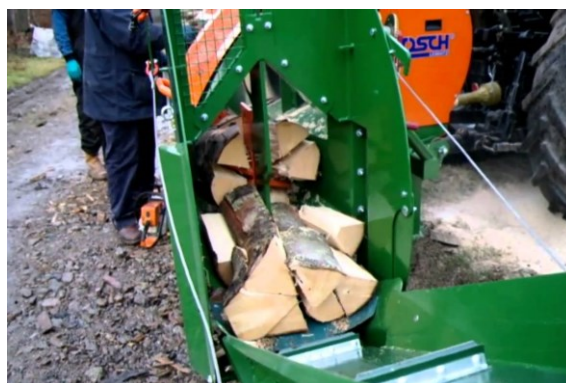
Slika 35. Cijepanje prepiljenog komada
