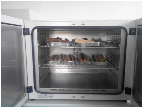
Slika 43. Utvrđivanje udjela vode metodom sušionika
