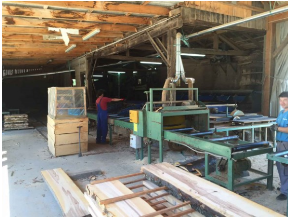
Slika 18. Čistač rezane građe prije slaganja u palete
