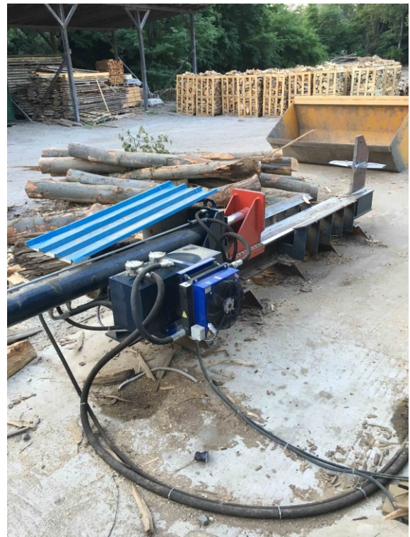
Slika 12. Horizontalni cjepač - stražnja strana
