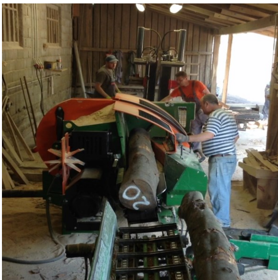
Slika 32. Hidraulički pokretana transportna traka
