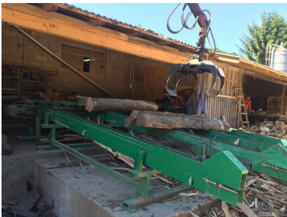
Slika 13. Utovar oblog energijskog drva na utovarnu rampu
