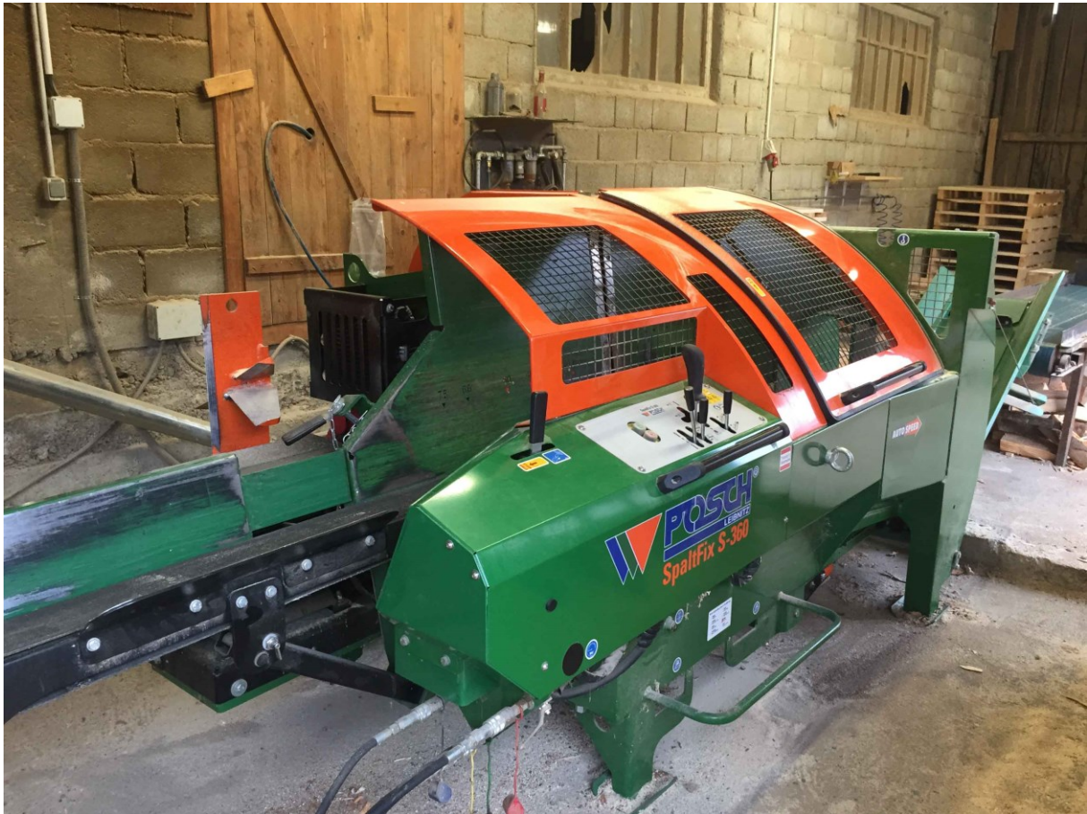
Slika 15. Istraživani model procesora Posch Spaltfix S-360
