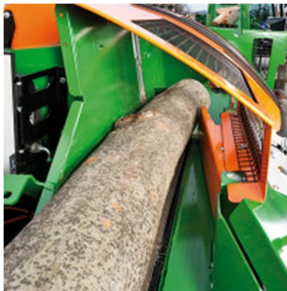
Slika 33. Klin za sprečavanje micanja prilikom prepiljivanja
