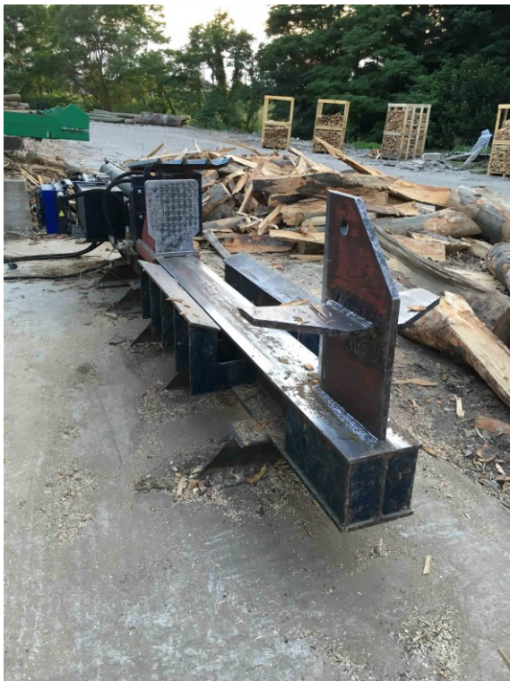
Slika 11. Horizontalni cjepač - prednja strana
