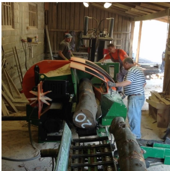
Slika 32. Hidraulički pokretana transportna traka
