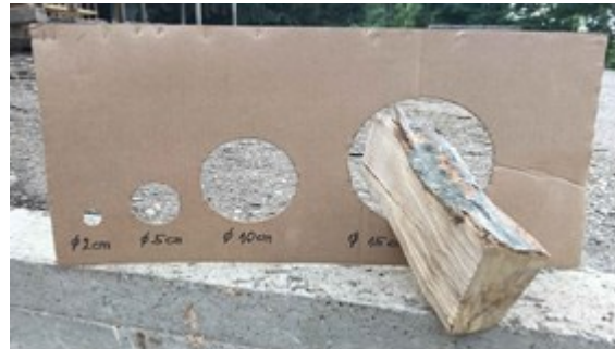
Slika 40. Šablona za izmjeru promjera cjepanice
