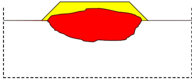
Slika 21. In-situ metoda: Izgradnja pokrovnog sloja (izvor: RGN, 2016)
