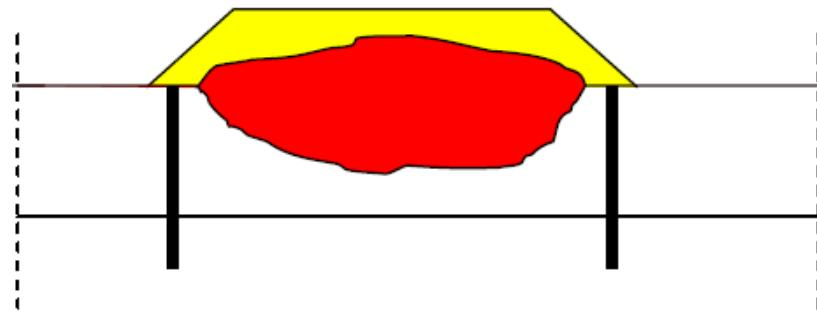
Slika 22. In-situ metoda: Izgradnja pokrovnog sloja s vertikalnom vododrživom barijerom (izvor: RGN, 2016)
