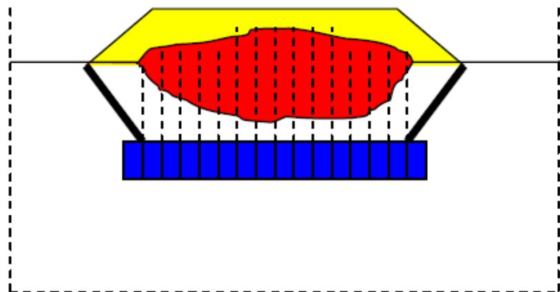
Slika 25. In-situ metoda: Izgradnja pokrovног sloja s horizontalnom vododrživom barijerom mlaznim injektiranjem (izvor: RGN, 2016)
