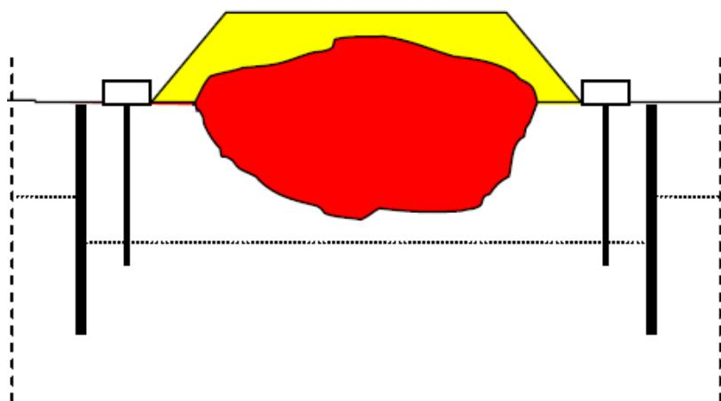
Slika 24. In-situ metoda: Izgradnja pokrovног sloja s vertikalnom vododrživom barijerom i sustavom za crpljenje podzemne vode (izvor: RGN, 2016)
