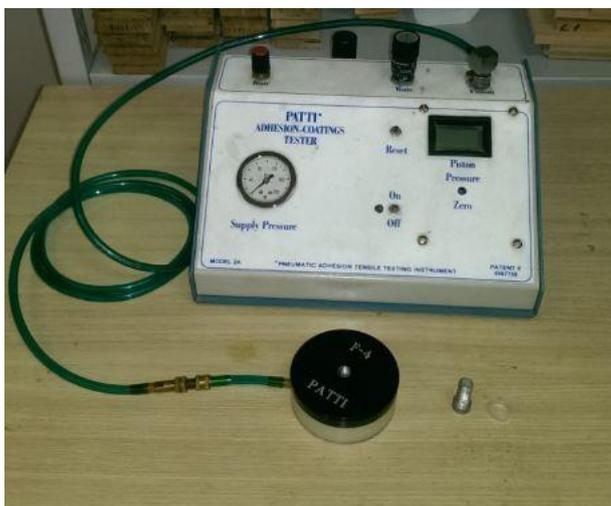
Slika 22. Instrument za određivanje adhezije metodom otkidanja valjčića
