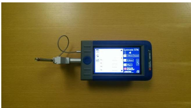
Slika 15. Instrument za mjerenje hrapavosti površine
