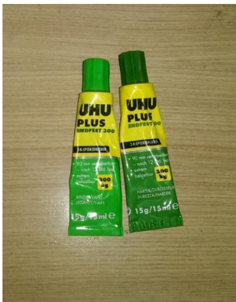
Slika 20. Dvokomponentno epoksidno ljepilo UHU plus 300
