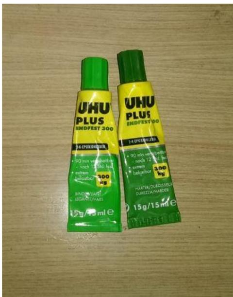
Slika 20. Dvokomponentno epoksidno ljepilo *UHU plus 300*
