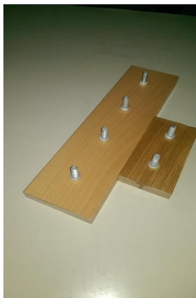
Slika 21. Prikaz zalijepljenih valjčića prilikom određivanja adhezije
