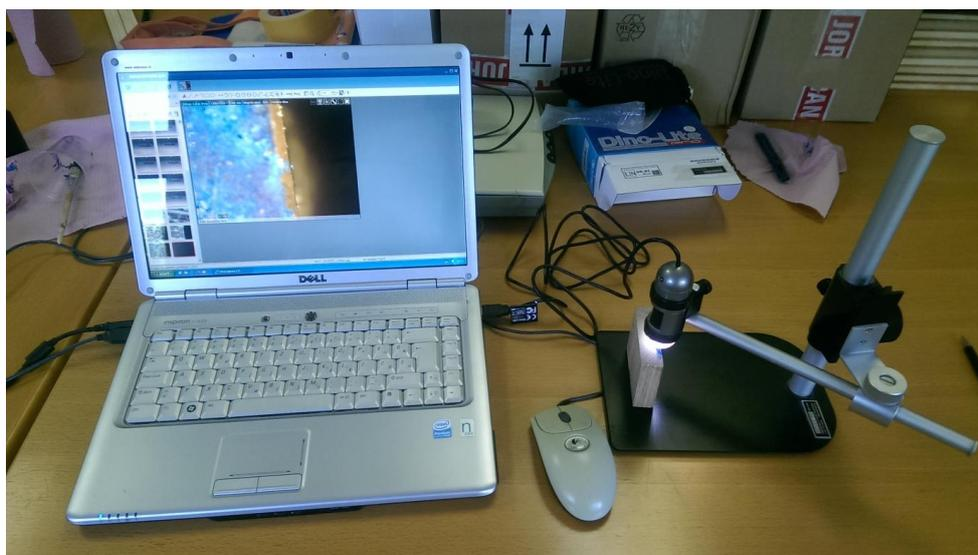
Slika 23. Određivanje debljine filma laka digitalnom kamerom
