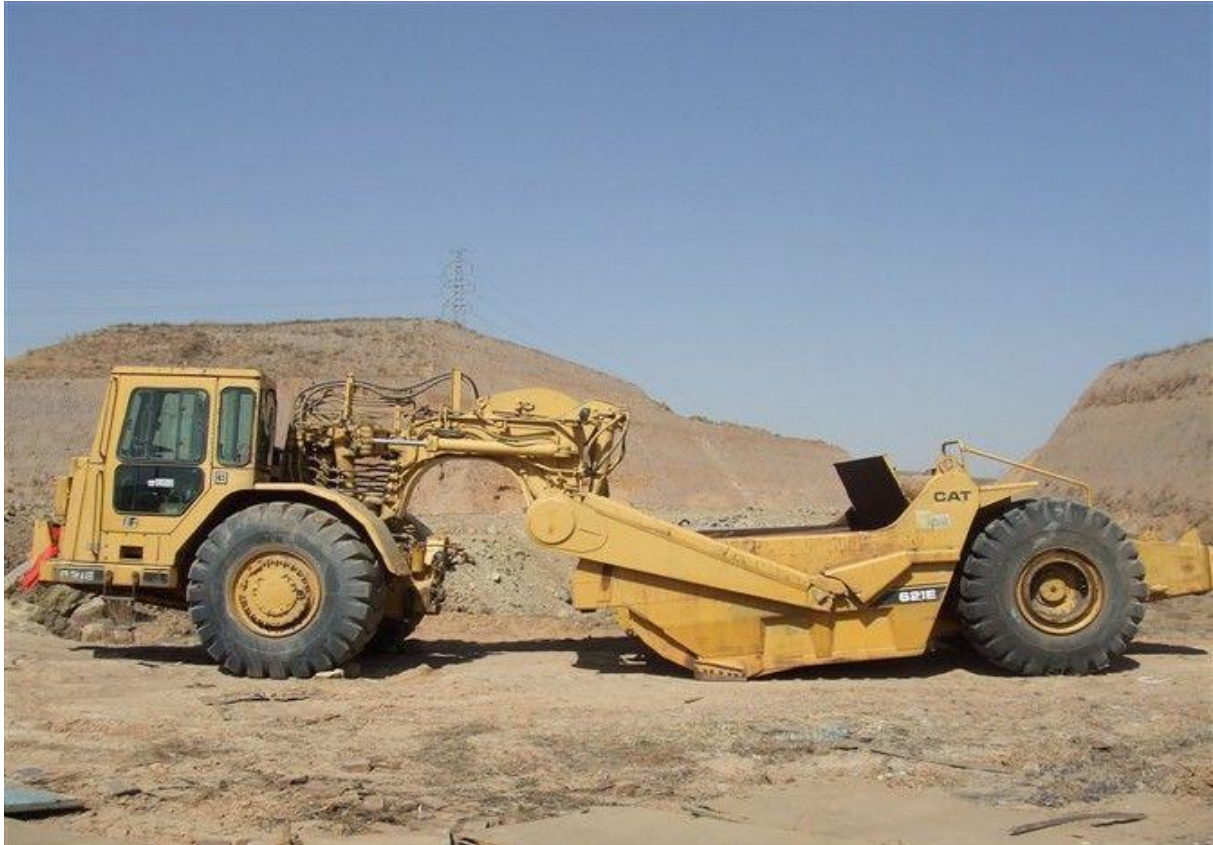
Slika 6. Skrejper - Caterpillar 621E
