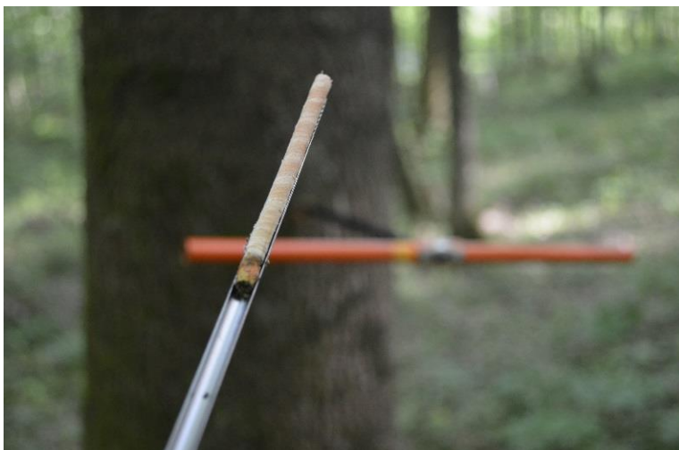
Slika 17. Uzimanje izvrtaka iz stabala glavnih vrsta drveća.
