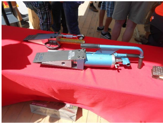
Slika 5. Mehanički klin za obaranje stabala
