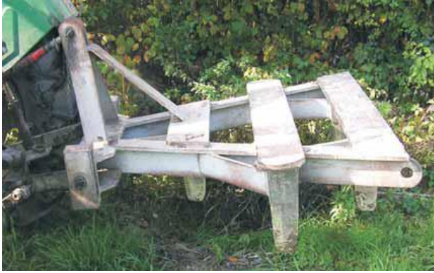
Slika 12. Grebač koji se priključuje na traktor i klinovi zavareni na dasku
