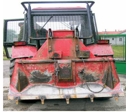
Slika 12. Grebač koji se priključuje na traktor i klinovi zavareni na dasku
