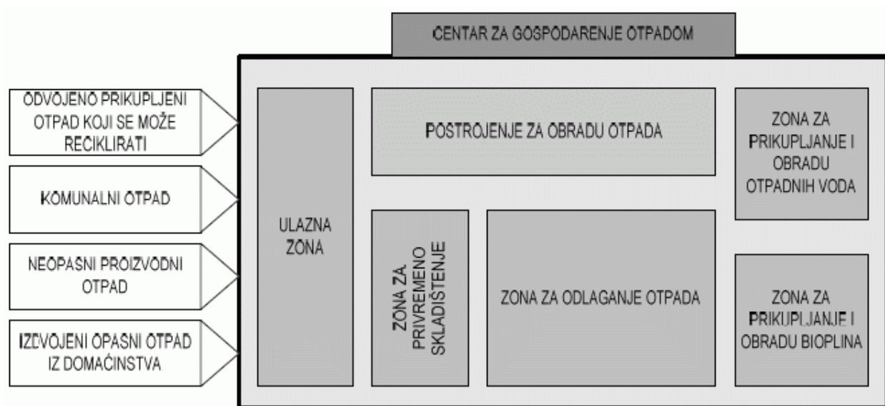
Slika 8. Shematski prikaz sastavnica centra za gospodarenje otpadom (Izvor: Plan gospodarenja otpadom u RH za razdoblje 2007. – 2015.)
