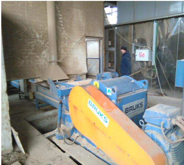
Slika 27. Bubanjski iverač BRUKS Klockner
