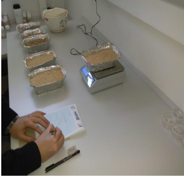
Slika 23. Vaganje uzoraka prije sušenja
