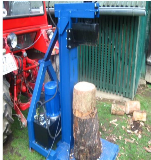
Slika 3. Hidraulički cjepač ( www.forum.hr )
