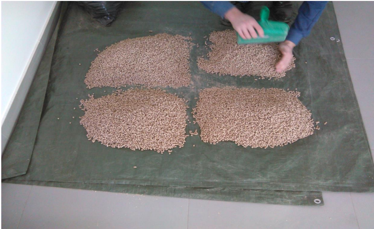
Slika 22. Priprema uzoraka četvrtinskom metodom
