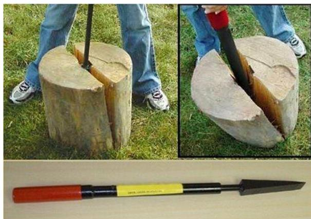
**Slika 10.** Ručni cjevač sa kliznim kladivom
