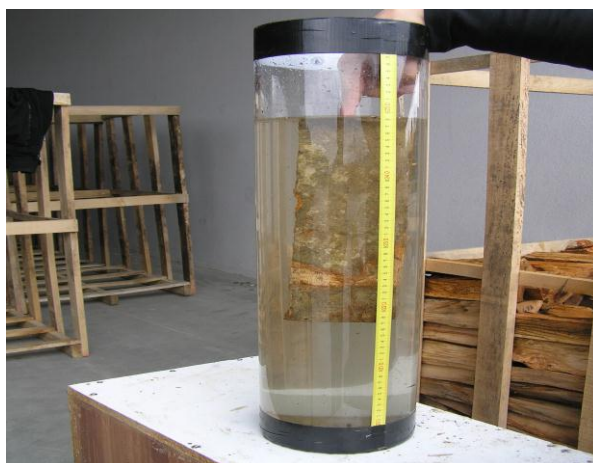
Slika 28. Mjerenje volumena cjepanica volumetrijskom metodom uranjanjem u menzuru
