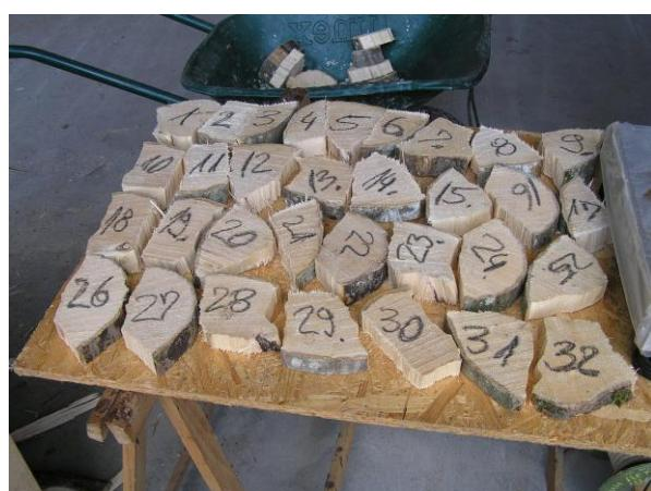
**Slika 29.** Uzorci iz cjepanica za potrebe mjerjenja vlage gravimetrijskom metodom
