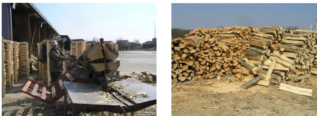
Slika 19. Cjepanje metrice hidraluičnim cjepačem i njezino međufazno skladištenje
