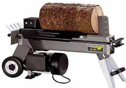
**Slika 12.** Hidraulični cjepač
