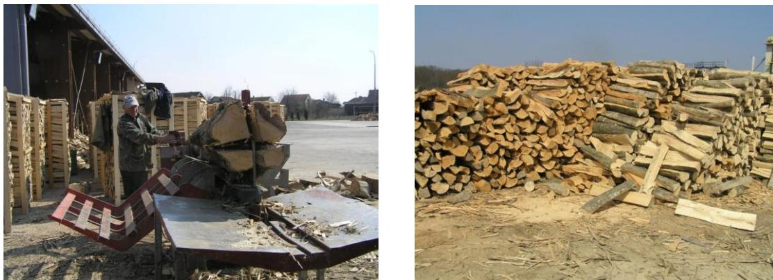
**Slika 19.** Cjepanje metrice hidrauličnim cjepačem i njezino međufazno skladištenje
