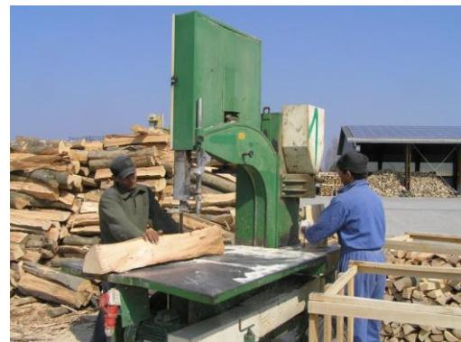
**Slika 20.** Piljenje metrice tračnom pilom na zadenu duljinu (lijevo) i složena paleta kratkih cjevanica (desno)
