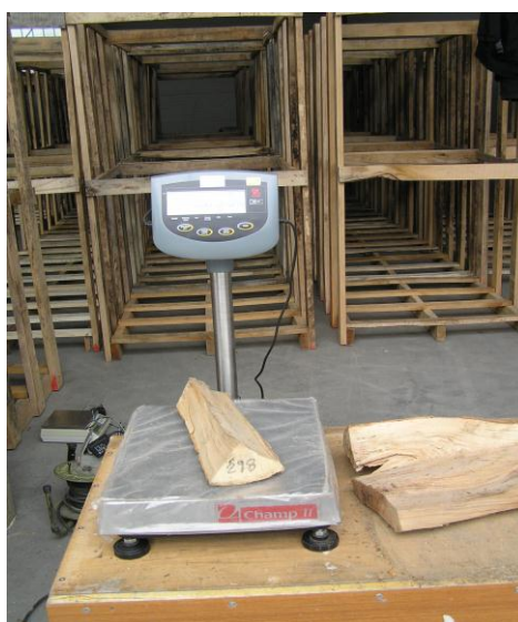
Slika 27. Mjerenje mase cjepanica na laboratorijskoj vazi
