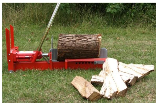
**Slika 9. Ručni hidraulični cjepač**
