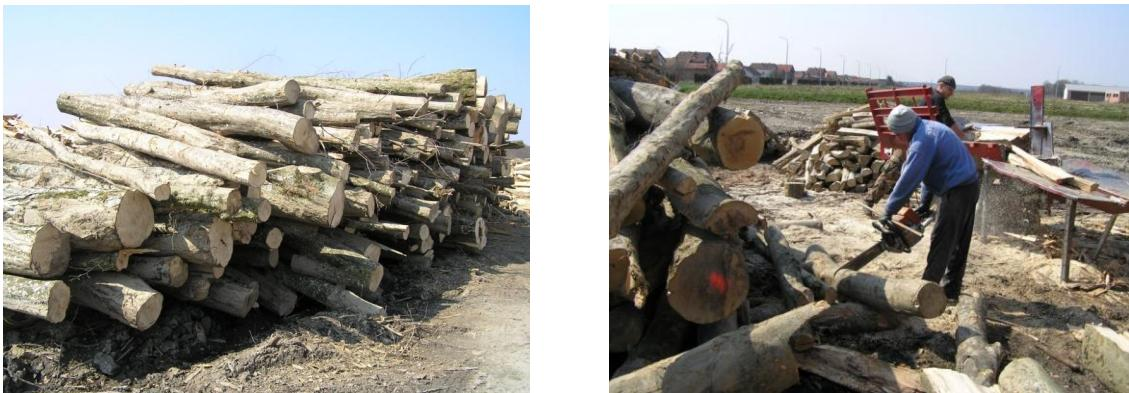
**Slika 18.** Stovarište oblovine i prekrajčivanje višemetrice motornom pilom na metricu
