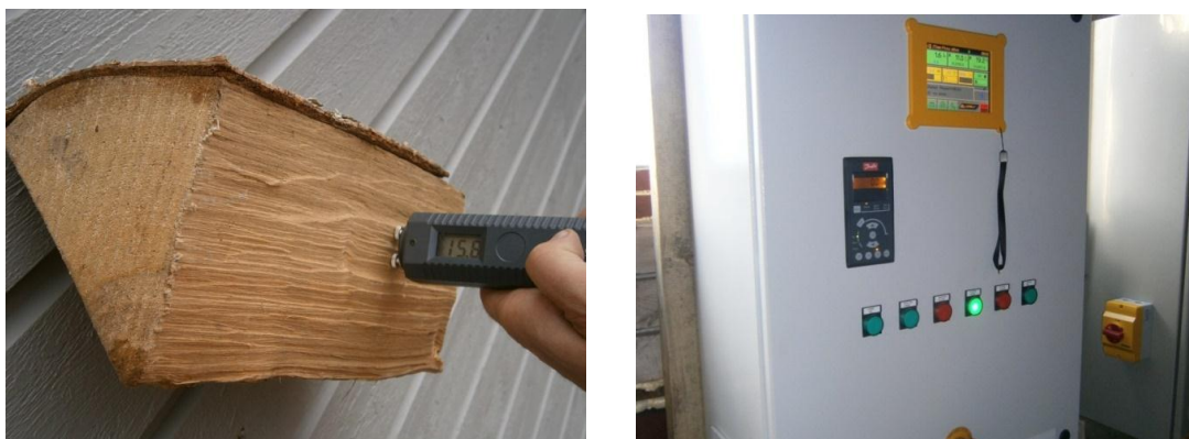
Slika 16. Mjerenje sadržaja vode u cjepanici
