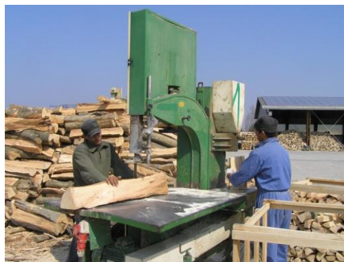
Slika 20. Piljenje metrice tračnom pilom na zadanu duljinu (lijevo) i složena paleta kratkih cjepanica (desno)
