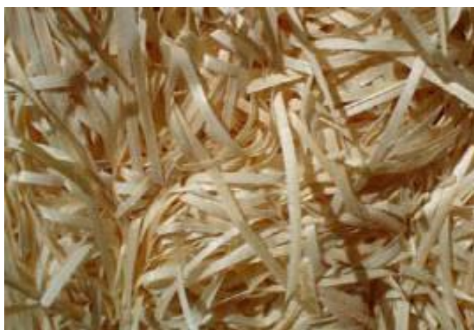
Slika 6. Drvena vlakna od kojih se proizvodi drvna vuna
