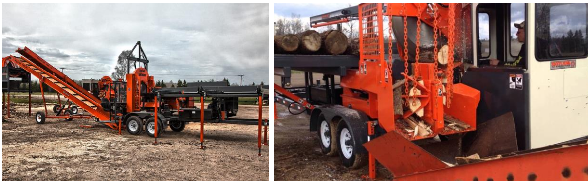
Slika 24. Multifunkcionalni stroj za piljenje i cijepanje ogrjevnog drva Izvor: http://www.multitekinc.com/products/firewood-processors/2020 https://www.youtube.com/watch?v=rA_fU5sACp4
