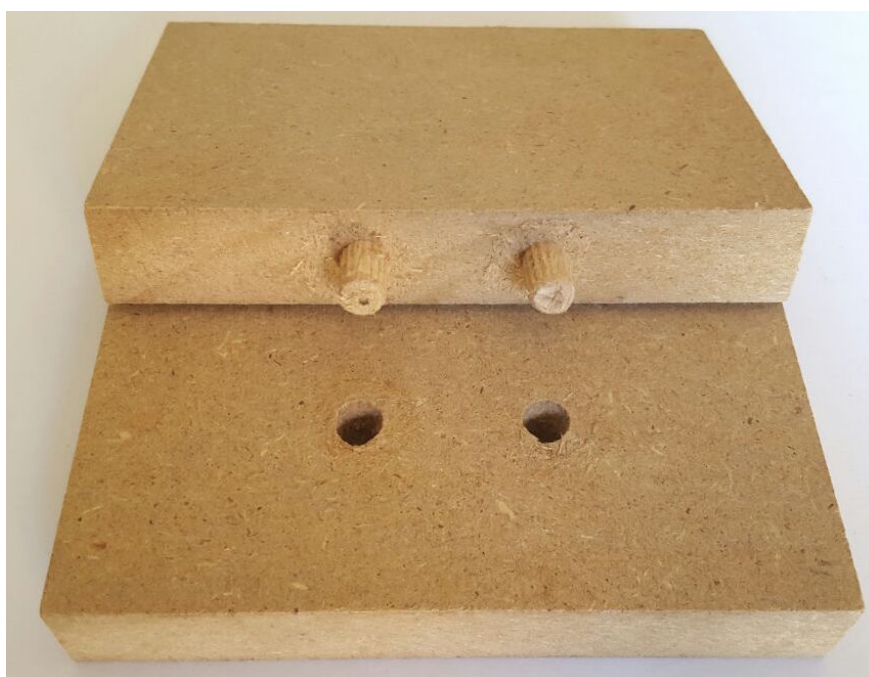
Slika 44. Uzorak M-MDF nakon ispitivanja izvlačne čvrstoće
