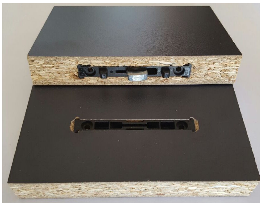
Slika 53. Uzorak C-IT nakon ispitivanja izvlačne čvrstoće
