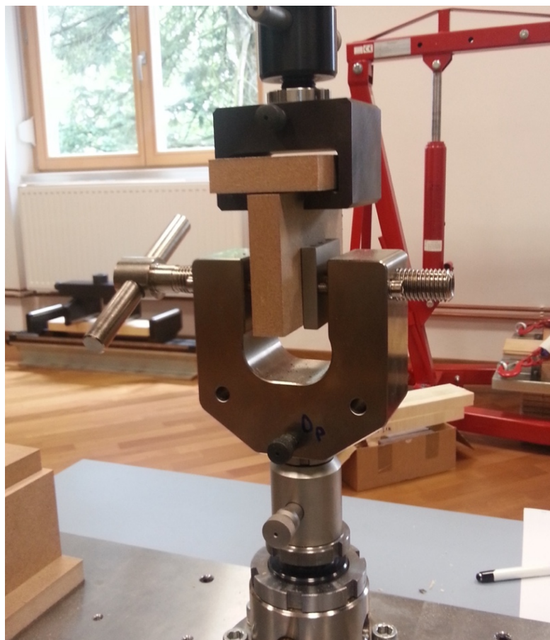
Slika 49. Uzorak T-MDF pri ispitivanju izvlačne čvrstoće
