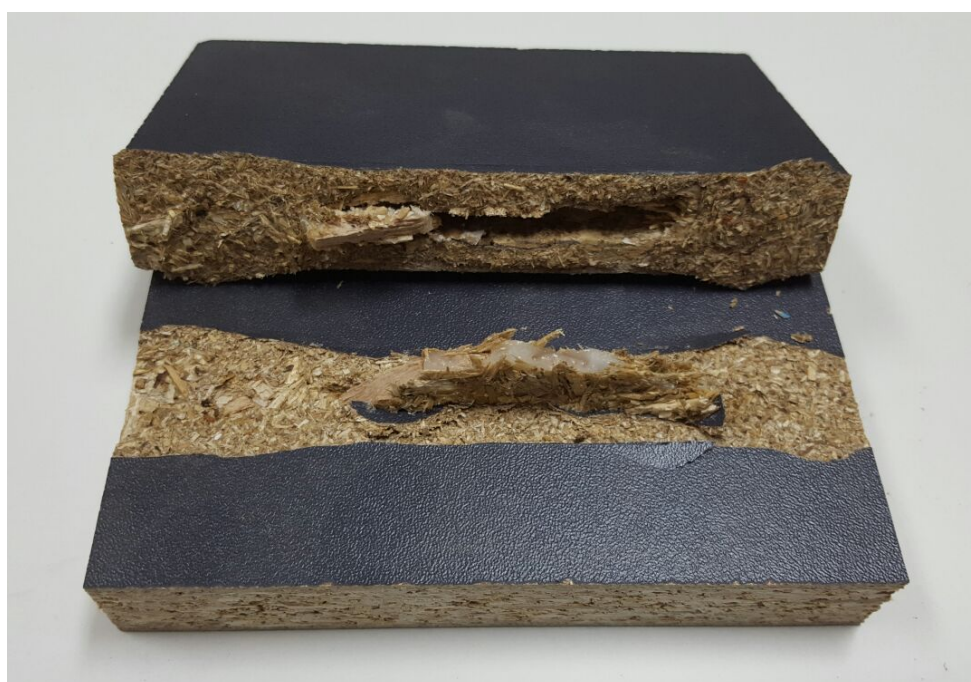
Slika 47. Uzorak L-IT nakon ispitivanja izvlačne čvrstoće
