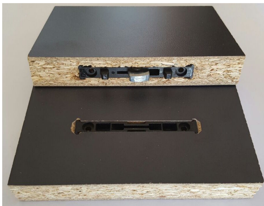
Slika 53. Uzorak C-IT nakon ispitivanja izvlačne čvrstoće
