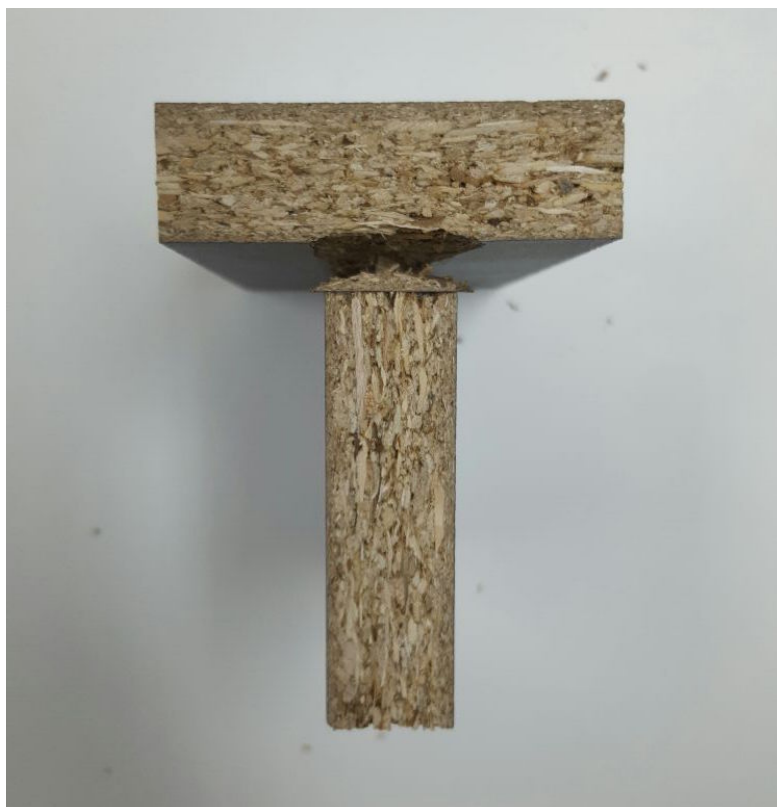
Slika 46. Uzorka L-IT pri ispitivanju izvlačne čvrstoće
