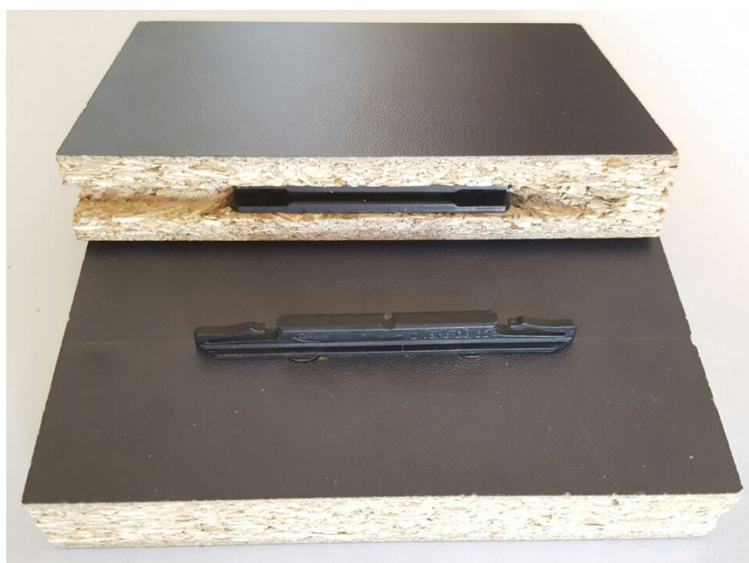
Slika 56. Uzorak D-IT nakon ispitivanja izvlačne čvrstoće
