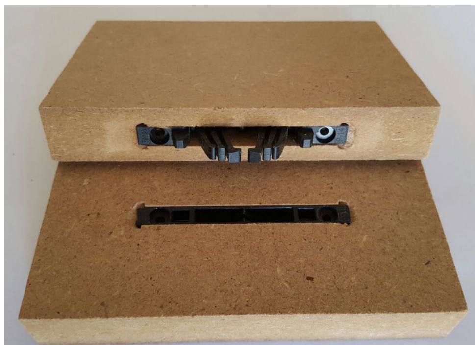
Slika 50. Uzorak T-MDF nakon ispitivanja izvlačne čvrstoće
