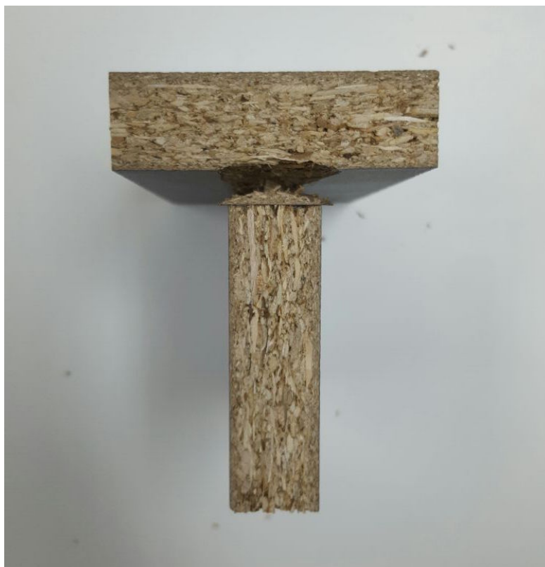
Slika 46. Uzorka L-IT pri ispitivanju izvlačne čvrstoće
