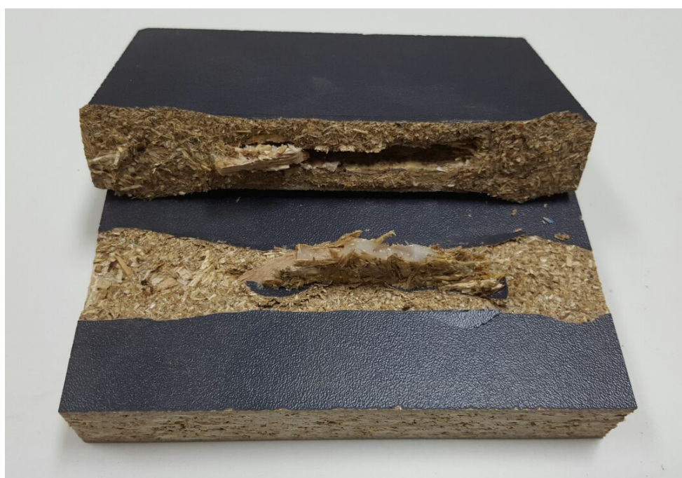
Slika 47. Uzorak L-IT nakon ispitivanja izvlačne čvrstoće
