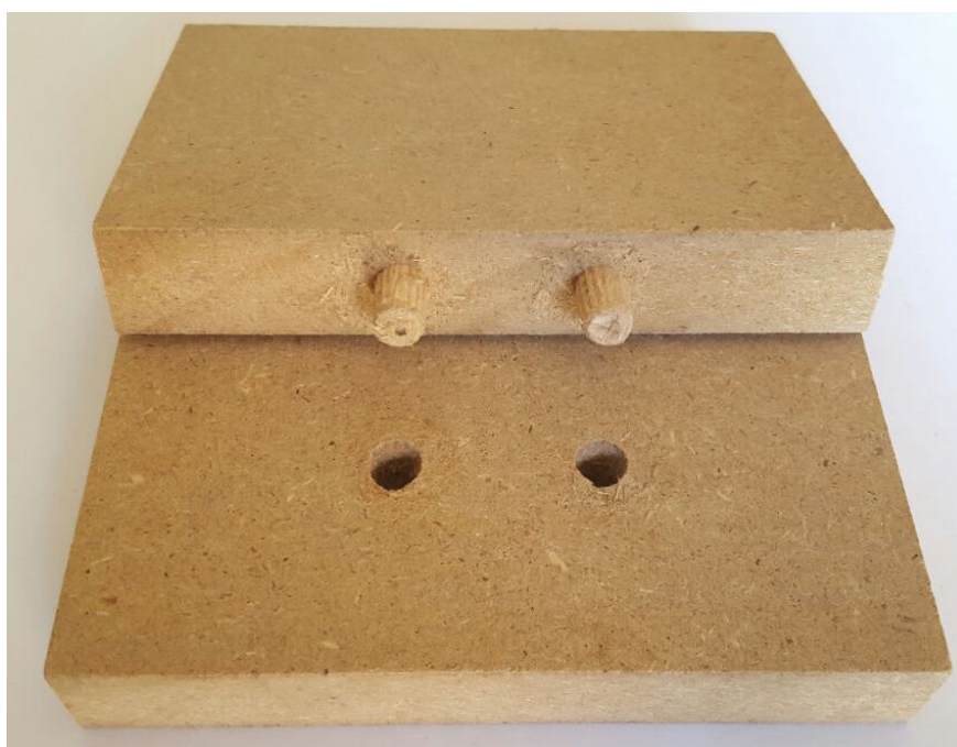
Slika 44. Uzorak M-MDF nakon ispitivanja izvlačne čvrstoće
