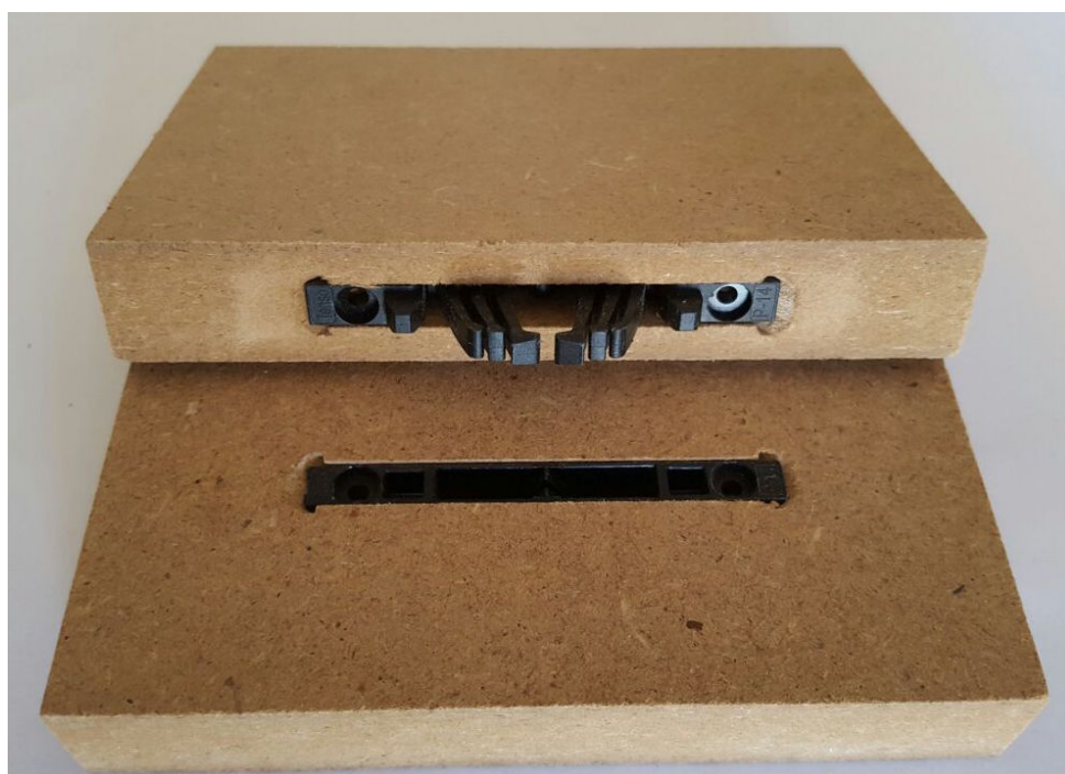
Slika 50. Uzorak T-MDF nakon ispitivanja izvlačne čvrstoće
