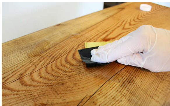
Slika 11 – Prikaz postizanja finijih površina brusnom tkaninom
