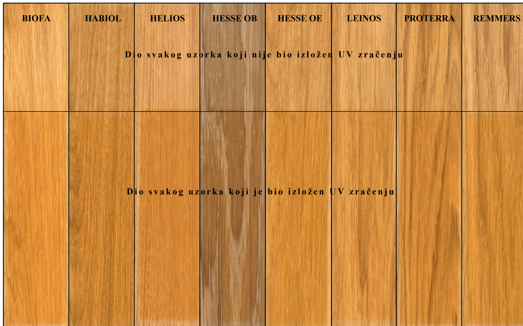
Slika 33 - Prikaz uzoraka hrastovine premazanih sa svih 8 ulja nakon tjedan dana izlaganja u QUV uređaju
