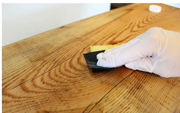
Slika 11 – Prikaz postizanja finijih površina brusnom tkaninom
