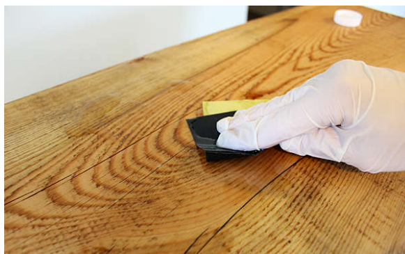
Slika 11 – Prikaz postizanja finijih površina brusnom tkaninom
