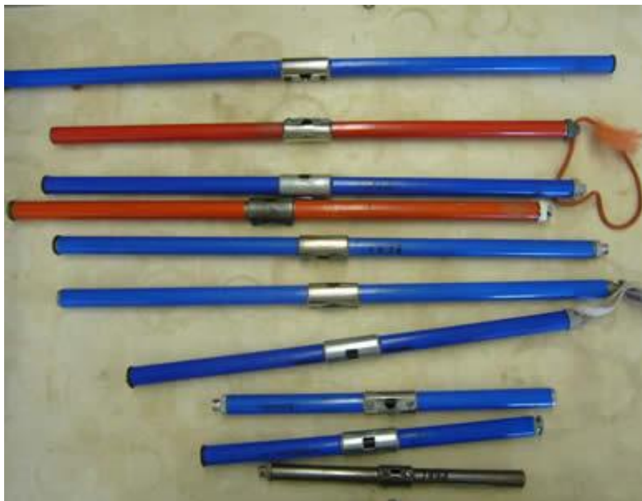
Slika 15. Presslerova svrdla raznih proizvođača i veličina ( http://www.esf.edu/fnrm/stella/facilities.html )
